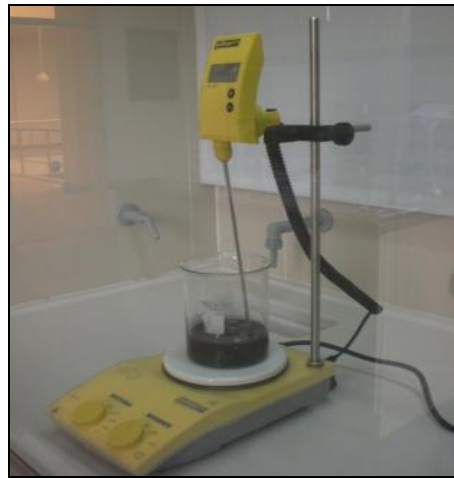
Şekil 3.4 : Çözümlendirme deneylerinde kullanılan deney setinin şematik ve gerçek gösterimi (1. 400 °C'lik kontak termometre, 2. Manyetik karıştırıcı, 3. Isıtıcı, 4. Magnet, 5. Cam beher, 6. Deney çözeltisi).
