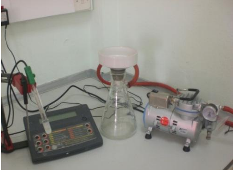
Şekil 3.5 : Çözümleme sonrası katı-sıvı ayrımının yapıldığı düzeneğin ve çözeltilerin pH değerlerinin ölçüldüğü pH metrenin görünümü.
