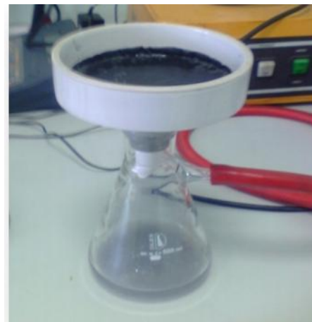
Şekil 4.11 : 1/10 K/S oranında gerçekleşen çözündürme işlemi sonucunda gözlemlenen jel yapısı.
