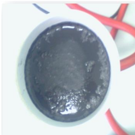
Şekil 4.11 : 1/10 K/S oranında gerçekleşen çözündürme işlemi sonucunda gözlemlenen jel yapısı.
