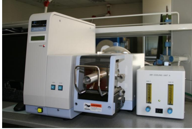
Şekil 3.1 : PerkinElmer™ Diamond TG/DTA cihazı.
