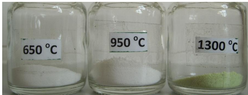
Şekil 4.1 : 650-950-1300°C’ de elde edilen \text{Sr}_{0,90}\text{Al}_2\text{O}_4\text{:Eu}_{0,05}, \text{Dy}_{0,05} (üre + borik asit katkı) toz numuneler.
