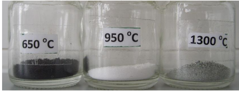
Şekil 4.11: 650-950-1300°C’ de elde edilen \text{Sr}_{0,90}\text{Al}_2\text{O}_4\text{:Eu}_{0,05}, \text{Dy}_{0,05} (Sitrik asit + borik asit katkılı) toz numuneler
