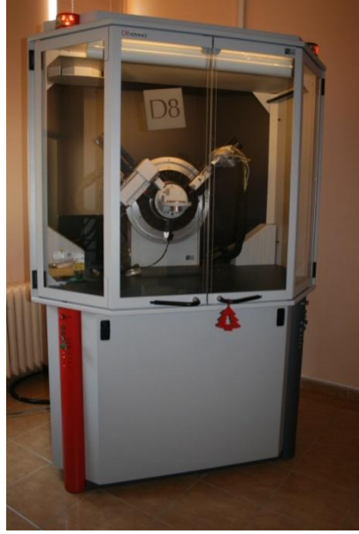
Şekil 3.2 : Bruker™ AXSD8 Advanced XRD cihazı.
