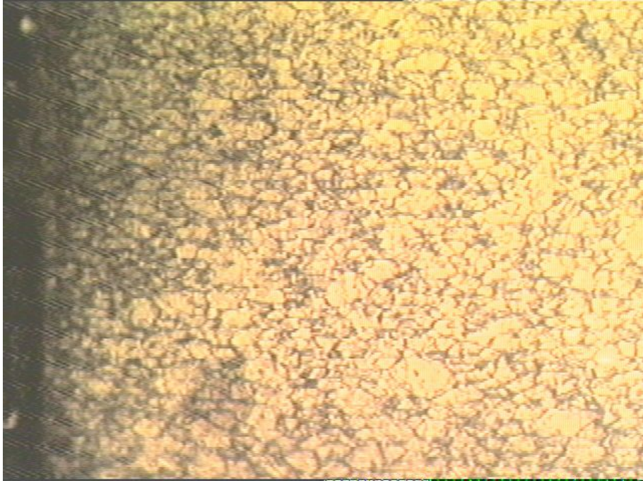
Şekil A.10. Avuç içi taşlama ile kesilen 316L çeliğin ısıt işlem sonrası 100x optik mikroskop fotoğrafı
