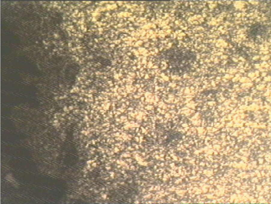
Şekil A.8. Su jeti ile kesilen 316L çeliğin ısıt işlem sonrası 100x optik mikroskop fotoğrafı
