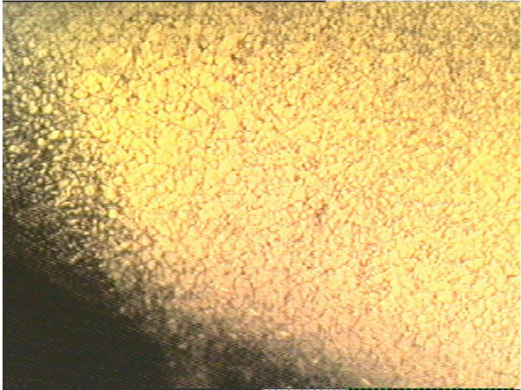
Şekil A.6. Plazma kesme ile kesilen 316L çeliğin ısıtıl işlem sonrası 100x optik mikroskop fotoğrafı
