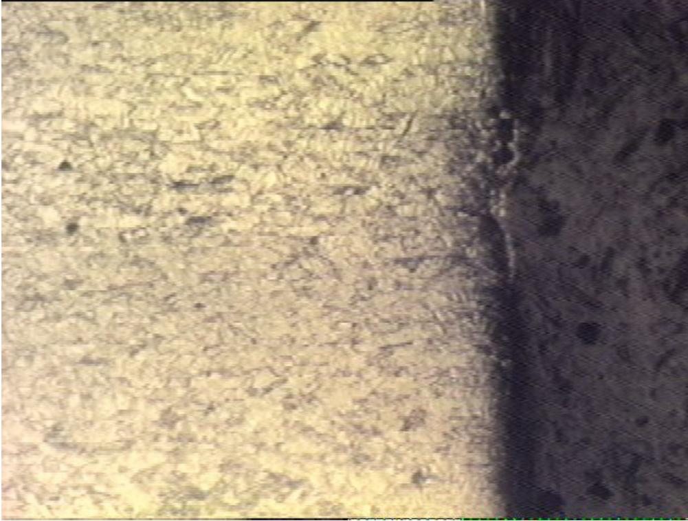
Şekil 6.6 : 0,91 mJ ışın enerjisi ve 5500 Hz frekans ile lazer kesimi yapılan 316L çeliğin 100x optik mikroskop fotoğrafı
