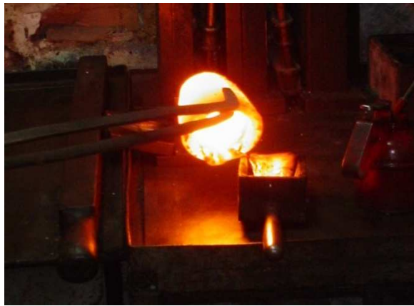
Şekil 3.2: Ergitilen metalin potadan kalıba dökümü yapılırken
