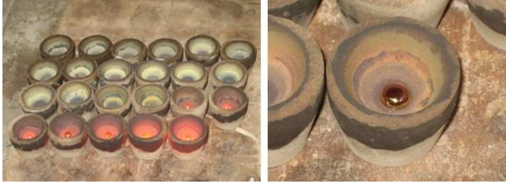
(a) Soğumaya bırakılan küpeller (b) Küpel içinde oluşan altın bulyon
