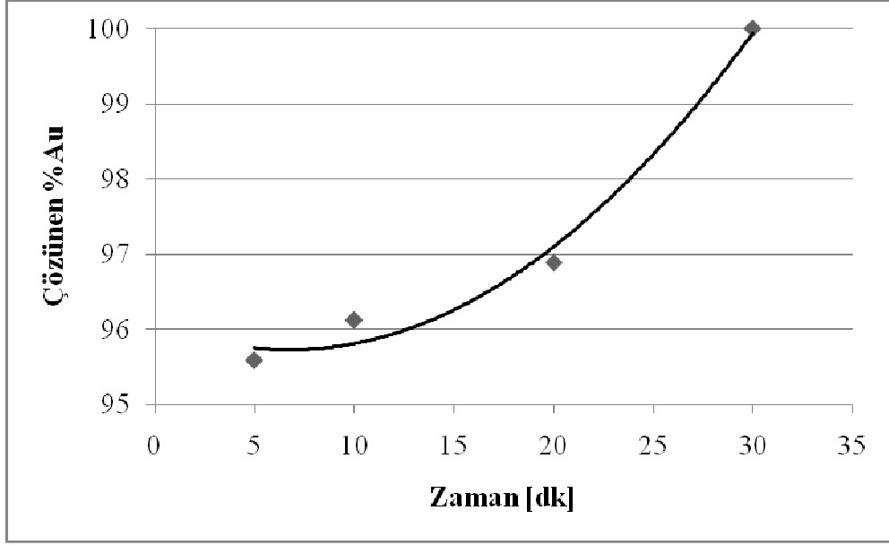
Şekil 4.3: 1ml HNO 3 kullanıldığında zamana bağlı altının çözünme verimi
