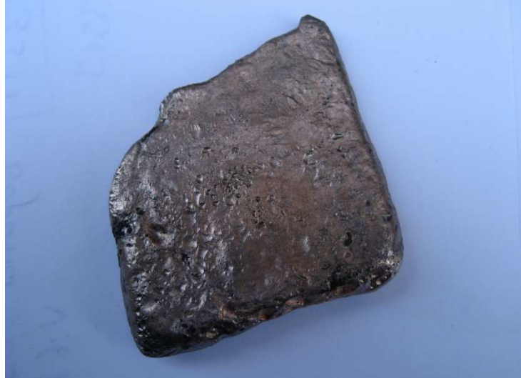
Şekil 4.27: Ergitme sonucu elde edilen bakır altın alaşımı
