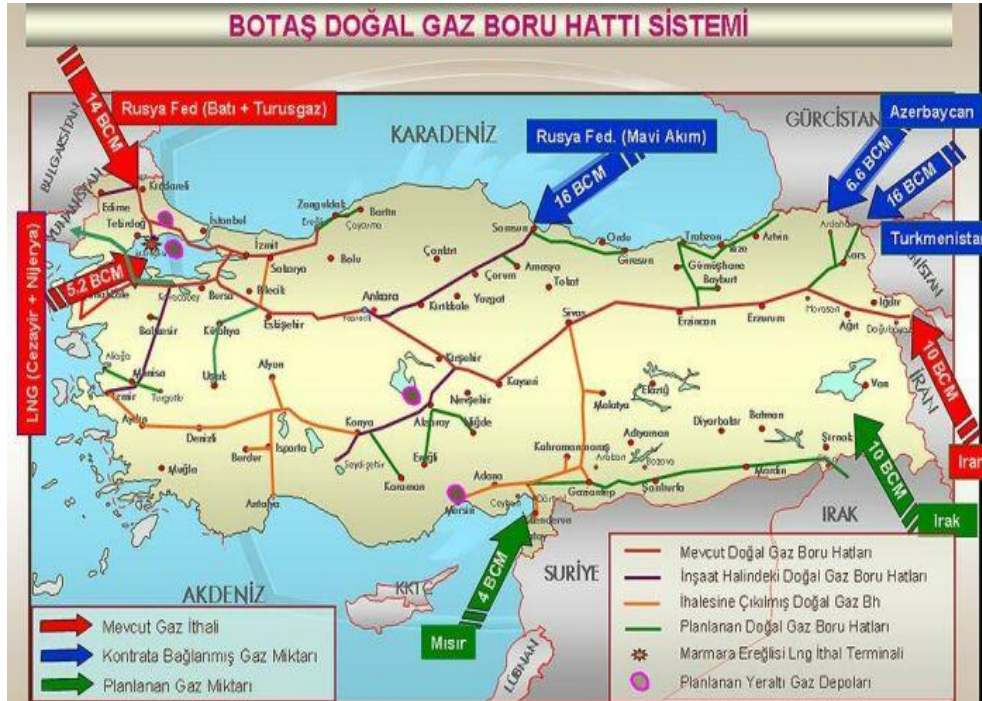
Şekil 5.9: Doğalgaz boru hattı sistemi [38].
