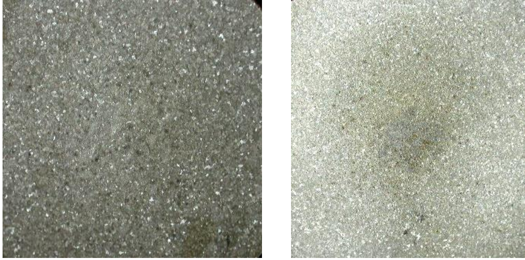
Şekil 4.2 : Makrografik Yapı, Sağda: 6 No'lu Numune , Solda : 8 No'lu Numune
