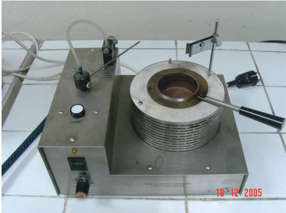
Şekil 3.5. Numunelerin açık kap alev alma sıcaklıklarının ölçüldüğü SETA marka cihaz.
