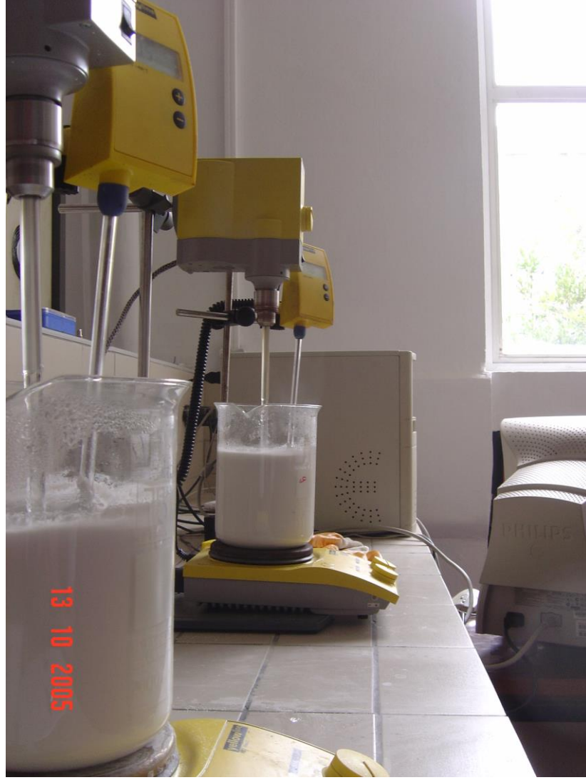
Şekil 3.4. Yerli kaynaklardan çinko borat üretimi deneylerinin yapıldığı düzenekler.
