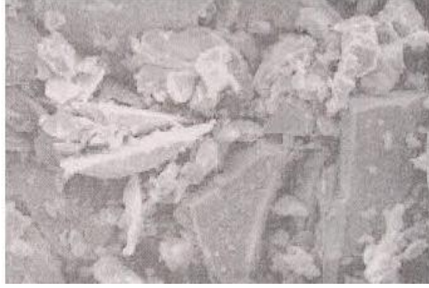
Şekil 3.3 Yüksek alüminalı dökülebilir refrakterde alümina tanelerinin SEM görüntüsü [29]
