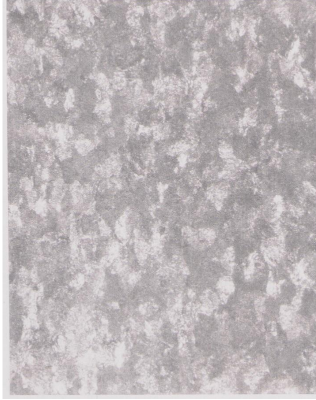
Şekil 6.3. 8006 alaşımasının enjeksiyon cihazı ile degaze edilmesinden sonra elde edilen metalografik imaj (X100)
