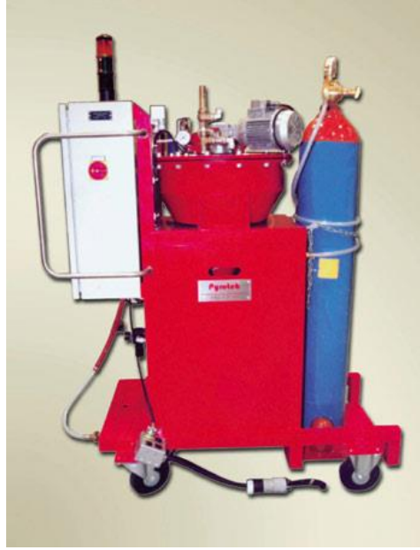
Şekil 4.2 Pyrotek FIF-50 gaz ve flaks enjeksiyon cihazı [14]
