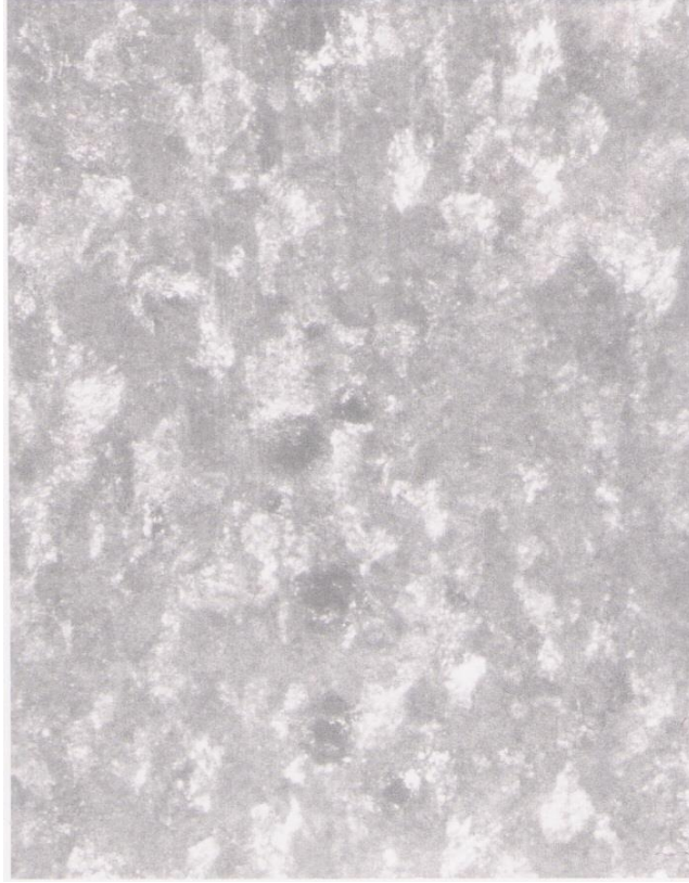
Şekil 6.1. 8006 alaşımlarının tablet ile degaze edilmesinden sonra elde edilen metalografik imaj (X100)
