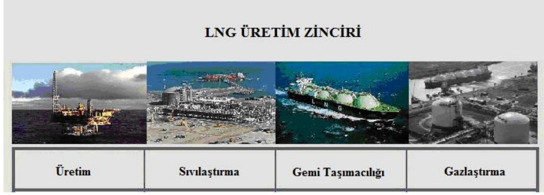
Şekil 3.1 : LNG Üretim Zinciri
