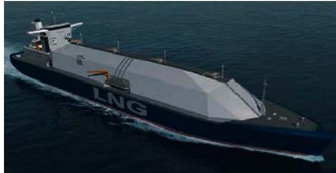
Şekil 1.5 : Yeni Nesil Moss-Rosenberg Tipi Bir Gemi Dizaynı
