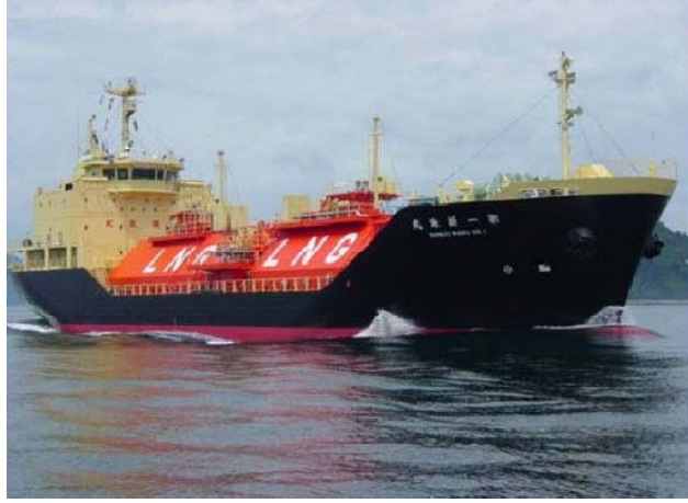
Şekil 1.8 : Tip “C” Tanklı Bir LNG Gemisi
