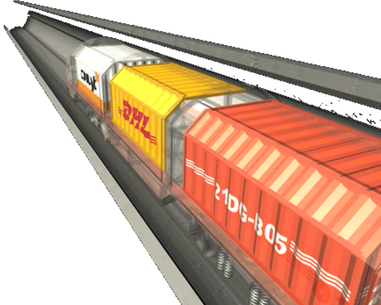
Şekil 6.3: Yeraltı Katı Yük Boru Hattı
