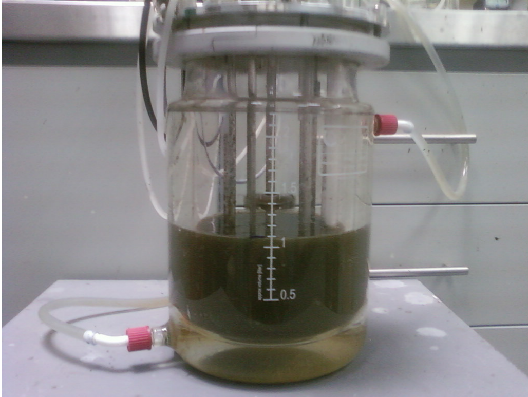
Şekil 4.2 : Applicon BioConsole Fermentör ve aşı çamuru
