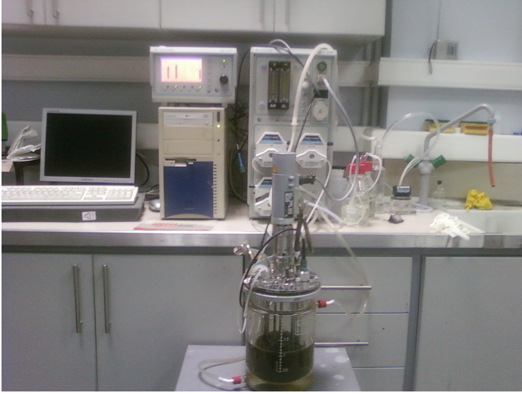
Şekil 4.1 : Applicon BioConsole Fermentör ve kontrol mekanizması
