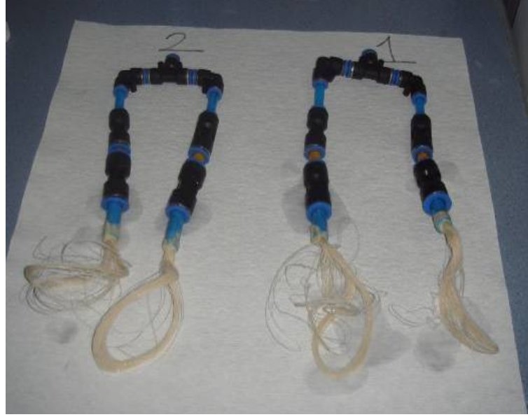
Şekil 3. 4 : Laboratuar ölçekli deneysel çalışmalar için hazırlanmış MF membranlar
