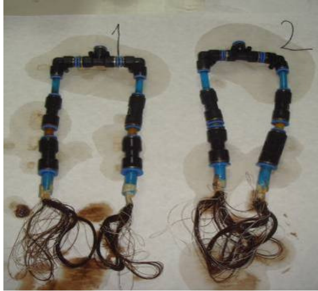
Şekil 3. 8 : Temizleme işlemi öncesinde MF membranların görünümü
