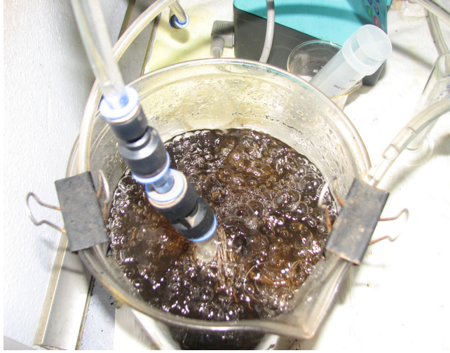
Şekil 3. 16 : Yüksek hümkik asit konsantrasyonuna sahip sentetik suda karbon nanotüpü ile yürütülen deneye ait reaktör içinden görünüm
