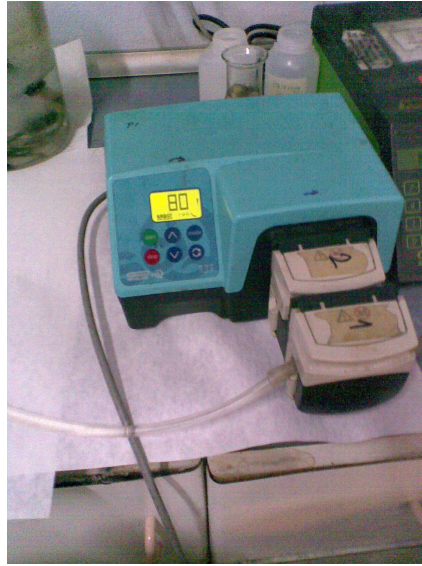
Şekil 3. 19 : Vakum basıncını sağlamak amacıyla kullanılan peristaltik pompa
