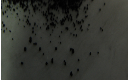
Şekil 3. 22 : Dış çapı 30-50 iç çapı 5-15 nm olan Karbon nanotüpü partiküllerinin görünümü
