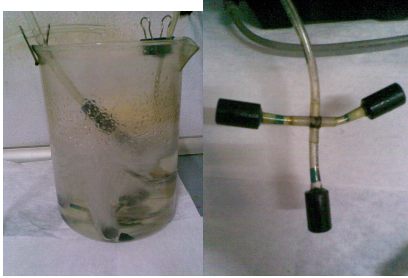
Şekil 3. 18 : Reaktör olarak kullanılan 3 litrelik beher ve havalandırma için kullanılan difüzör
