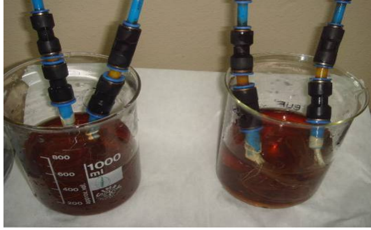
Şekil 3. 9 : Baz çözeltisi içinde MF membranların görünümü
