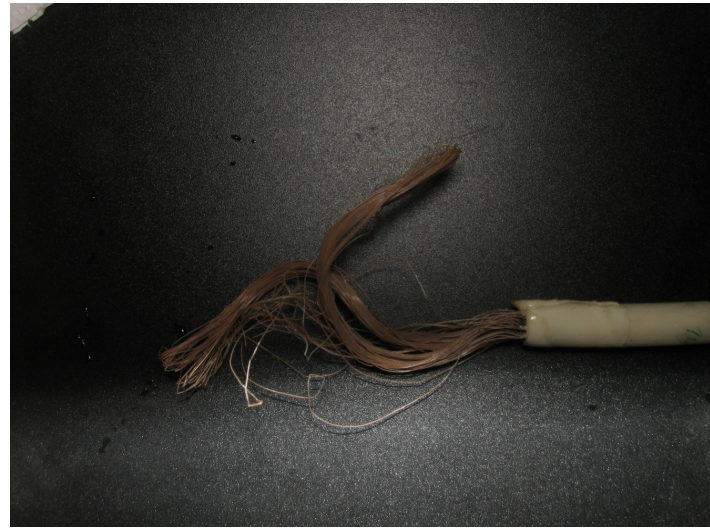
Şekil 3. 7 : Yüksek hüyük asit konsantrasyonundaki sentetik suda ardından MF membranının kullanım öncesi ve deney sonrası sudan geçirilmiş hali
