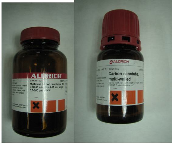
Şekil 3. 21 : Deneylerde kullanılan Karbon nanotüpü (multiwalled)
