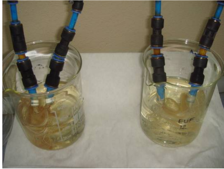
Şekil 3. 10 : Temizleme işlemi sonrasında MF membranların görünümü
