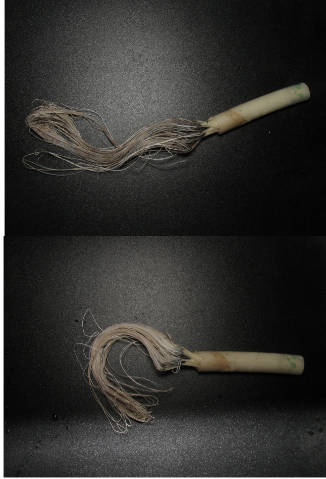
Şekil 3.6 : Ömerli göl suyunda yüksek dozda karbon nanotüpü ile yürütülen deney ardından MF membranının kullanım öncesi ve deney sonrası sudan geçirilmiş hali
