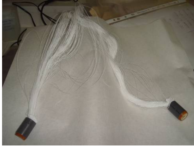
Şekil 3. 3 Deneyisel çalışmalarda kullanılan MF membranının ticari şekli
