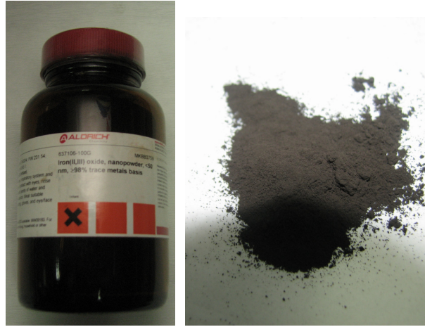
Şekil 3. 20 : Deneylerde kullanılan Fe (III) nanopartikülü
