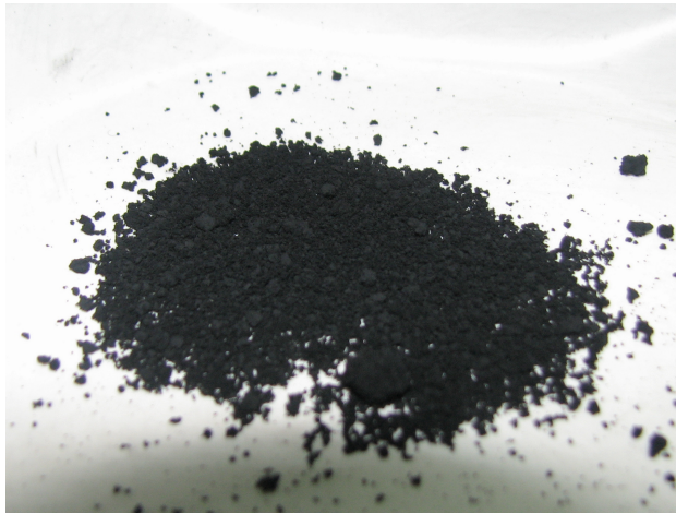
Şekil 3. 23 : Dış çapı 10-15 nm iç çapı 2-5 nm olan karbon nanotüpü partiküllerinin Görünümü
