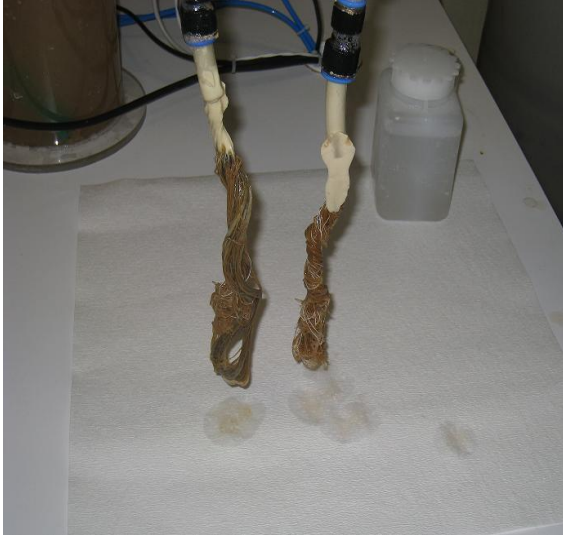
(a) Temizleme işlemi öncesinde MF membranların görünümü
