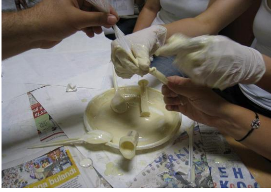
(g) Membran uçlarına yapıştırıcı ilavesi
