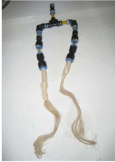
(c) Temizleme işlemi sonrasında MF membranların görünümü
