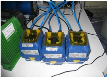
(g) Asit, baz ve kimyasal dozlama peristaltik pompaları
