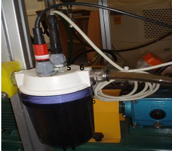
(c) İletkenlik,sıcaklık,pH problelerinin olduğu hazne (5), (6)
