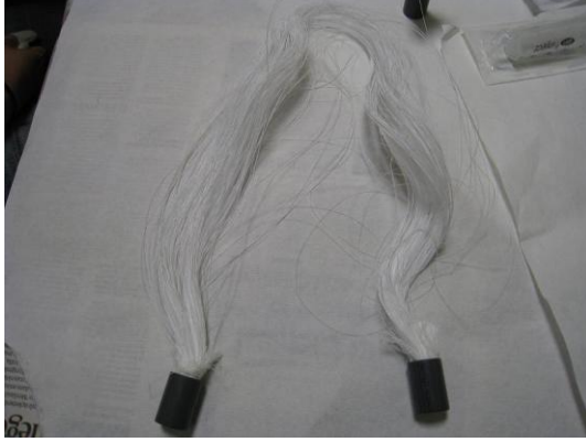
(a) 40 cm uzunluğunda 100 adet kesilen membran lifler
