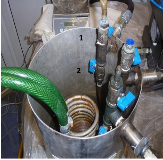
(a) Besleme tankı (1), Soğutucu borular (2)
