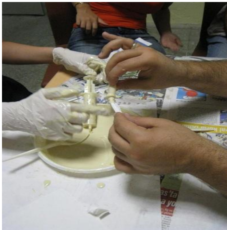
(e) Membranın pnömatik borunun ucundan çıkarılması
