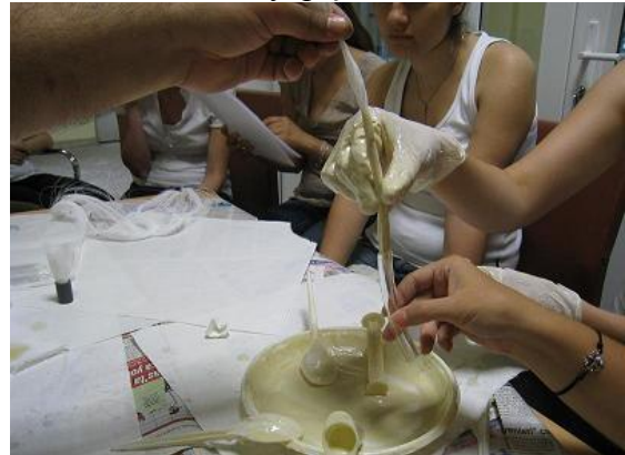
(d) Membranın pnömatik hortum içinden geçirilmesi
