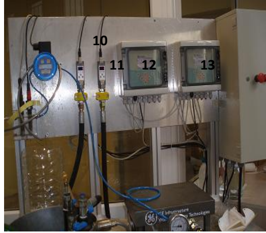
(f) Kütlesel debi (10), Membran girişi (11) Membran çıkışı (12) Basınç ölçerler, PLC ekranları (13)
