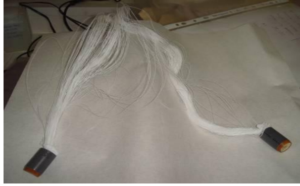
Şekil 3. 5 : Deneysel çalışmalarda kullanılan MF membranın görünümü.
