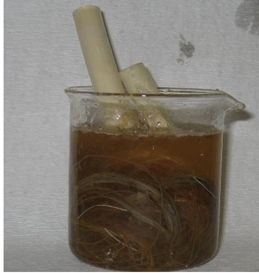
(b) Baz çözeltisi içinde MF membranların görünümü
