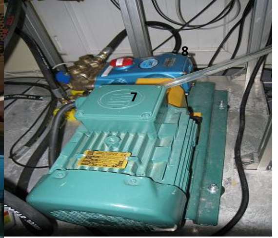
(d) Motor (7), Besleme pompası (8)
