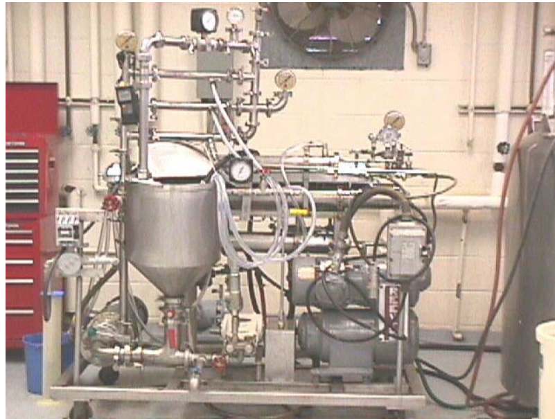
Şekil 2. 18 : Petrol üretim atıksuyu arıtımı için kurulmuş laboratuvar ölçekli ters osmoz sistemi (Patel, 2004).
