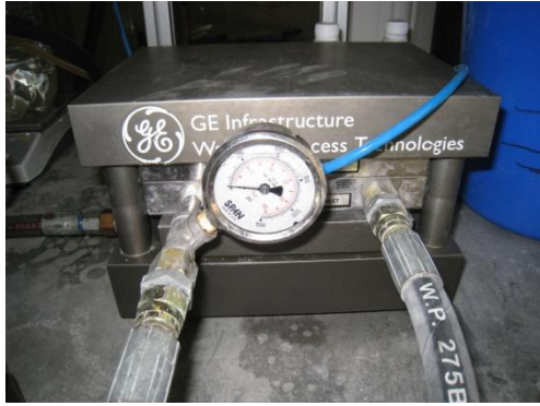
(g) Membran test hücresi
