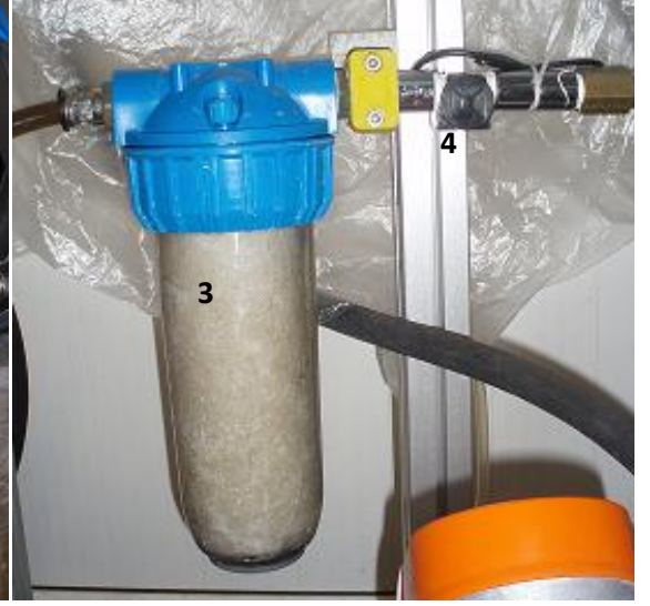
(b) Kartuş filtre (3), Debimetre(4)
