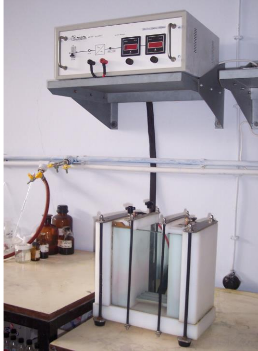
Şekil 4.2 : Elektrokoagülatör ve Dc Güç Kaynağının Birlikte Görünüşü
