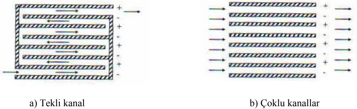
Şekil 3.8 : Tek ve Çoklu Kanallardan Su Akışı
