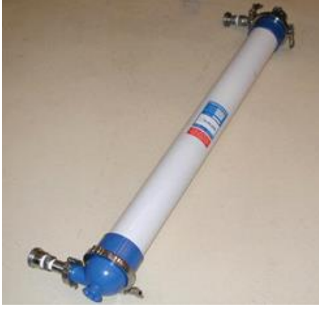
Şekil 5.9: Kullanılan membran modülü
