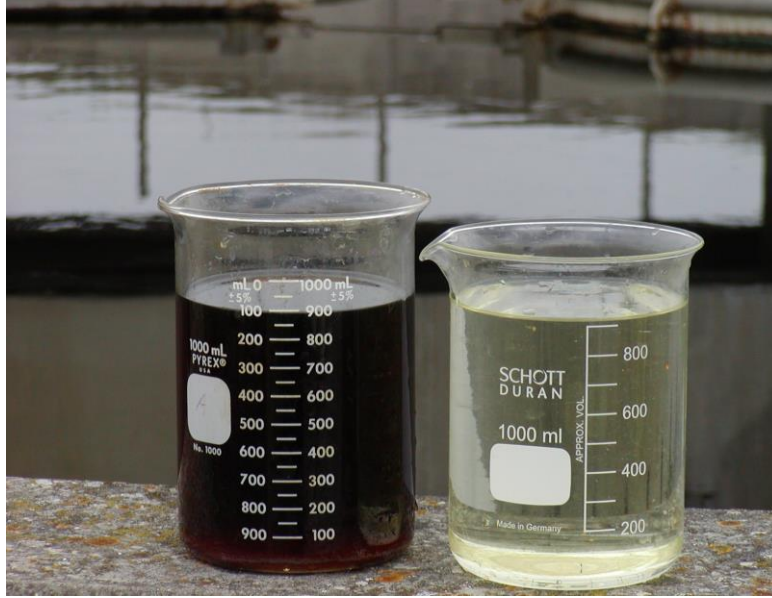
Şekil 4.4: Wijster’deki nanofiltrasyon pilot tesisinde giriş ve çıkış numuneleri
