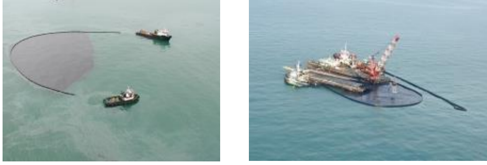
Şekil 3.4 Bariyerin U şeklinde çekilmesi ve sıyrıcı kullanımı (ITOPF, 2003)
