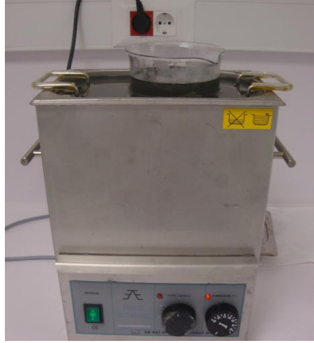
Şekil 3.3 : Çözelti içerisinde bulunan hava kabarcıklarının alındığı sonikatör.
