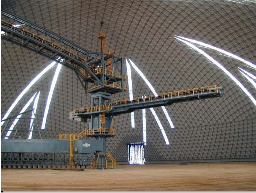
Şekil 3.3 : Örnek bir homojenizasyon sistemi.
