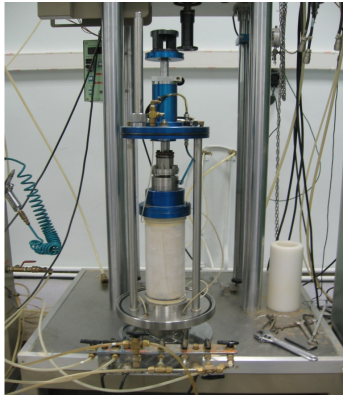
Şekil 3.1 Üç eksenli deney sisteminin genel görünümü
