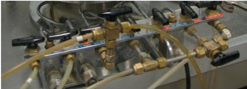
Şekil 3.2 Hücre alt tablasına bağlı vanaların gösterimi
