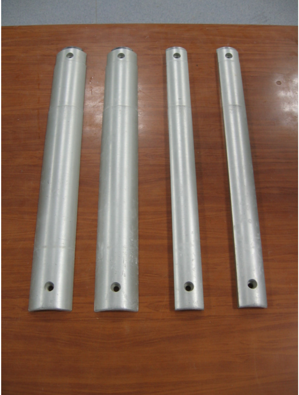
Şekil 3.9 Numune hazırlama aşamasında kullanılan iç kalıplar
