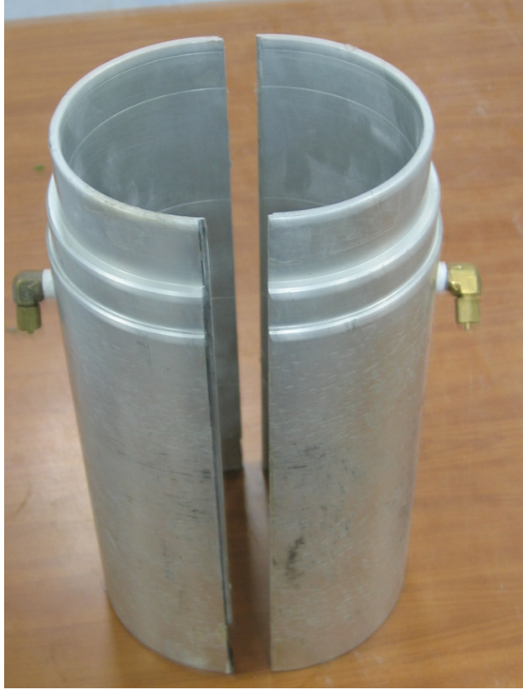
Şekil 3.11 Numune hazırlama aşamasında kullanılan dış kalıplar
