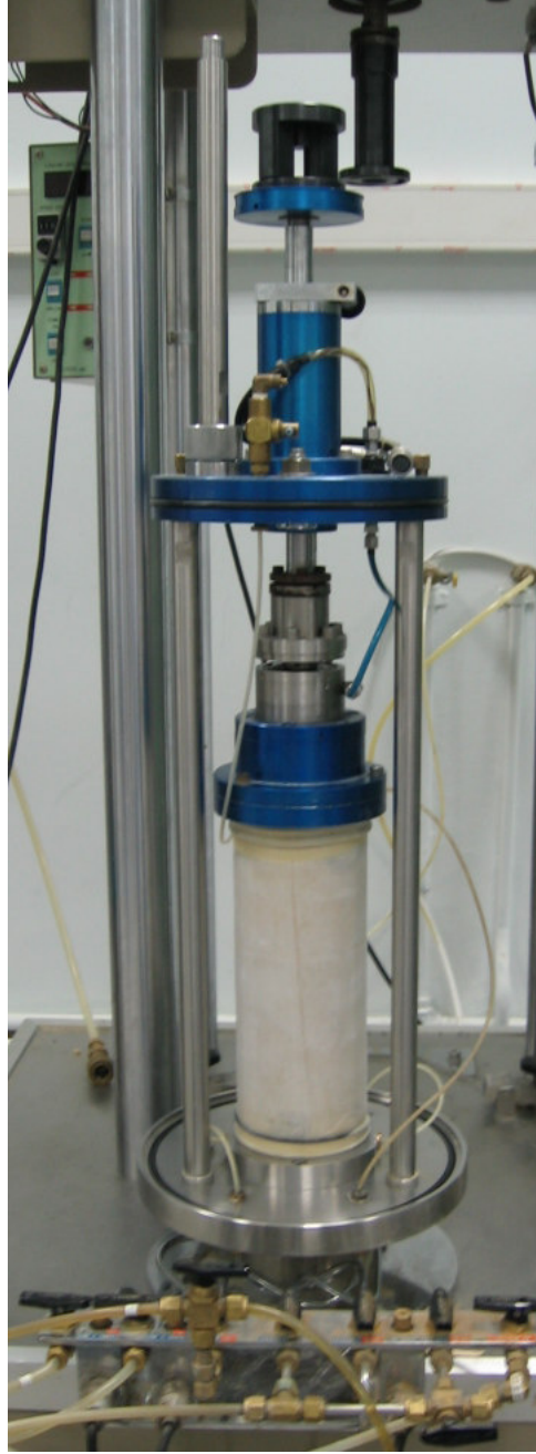
Şekil 3.15 Üç eksenli tripodun numunenin üst başlığına takılması durumu
