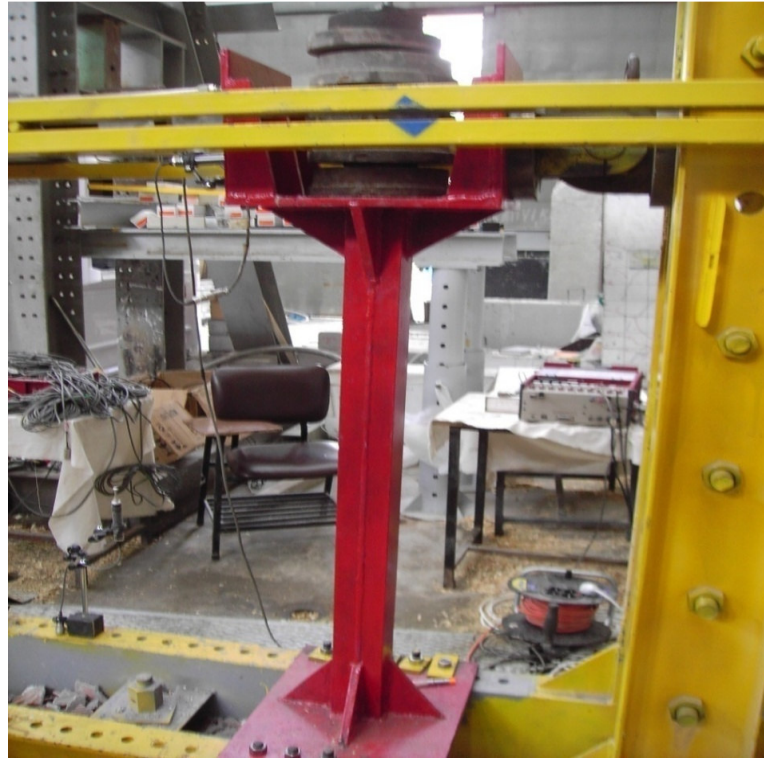
Şekil 4.5: Deney Düzeneğine Yerleştirilmiş Tek Serbestlik Dereceli Çelik Konsol Kolon Sistemi
