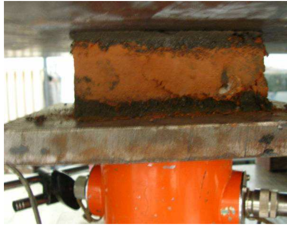
Şekil 4.10: Tekli Tuğla Numunelerde Basınç Deneyi
