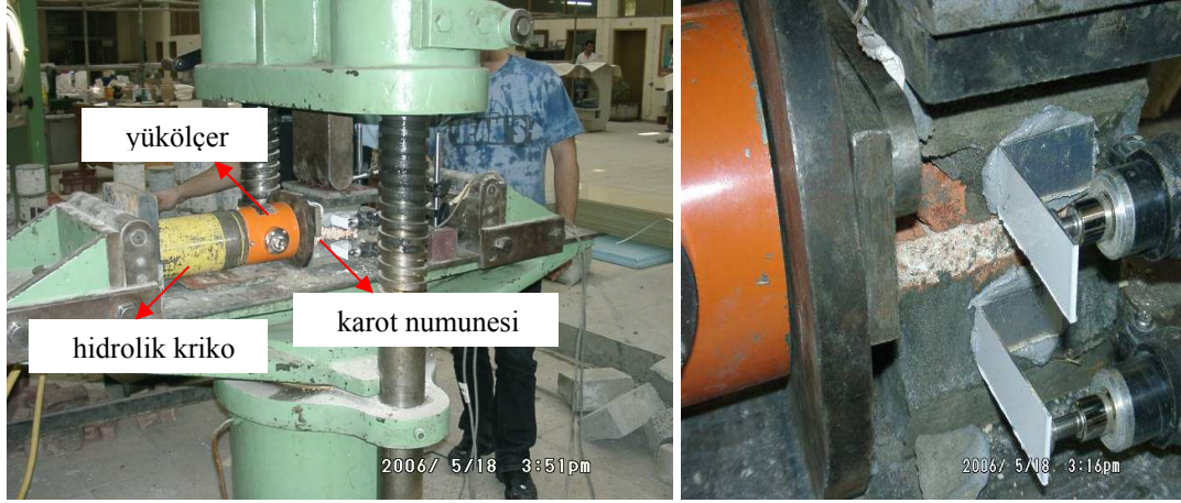
Şekil 4.7 Karot Kayma Deneyi
