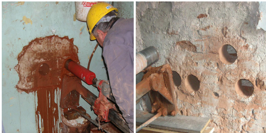
Şekil 4.4: Karot Numune Alınması
