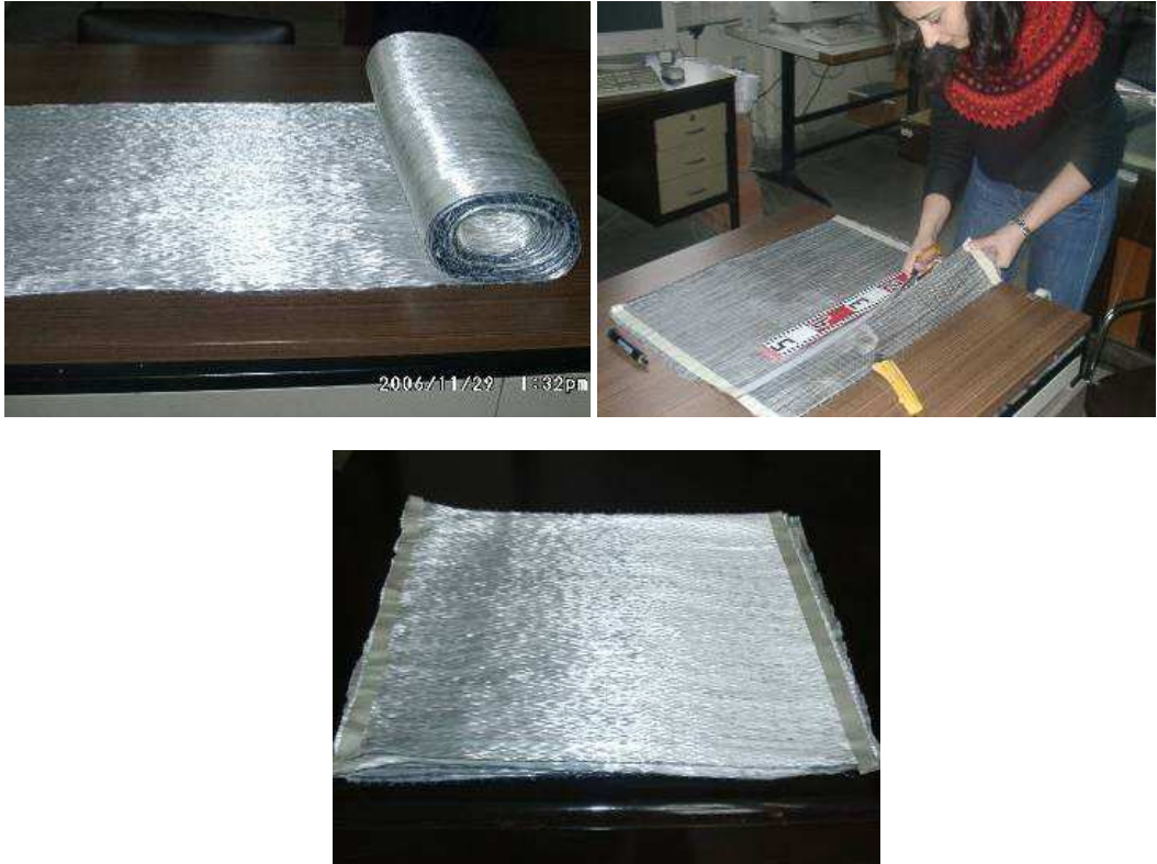
Şekil 4.31: Cam Lifli Kumaşların Hazırlanması
