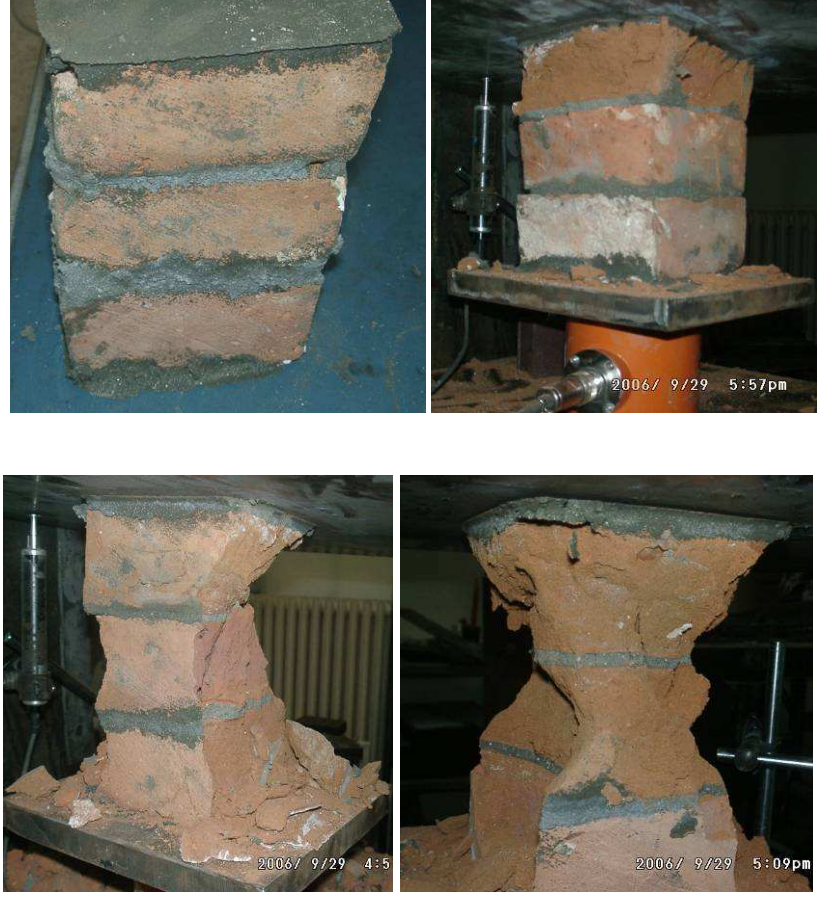
Şekil 4.13: Üçlü Tuğla Numunelerde Basınç Deneyi
