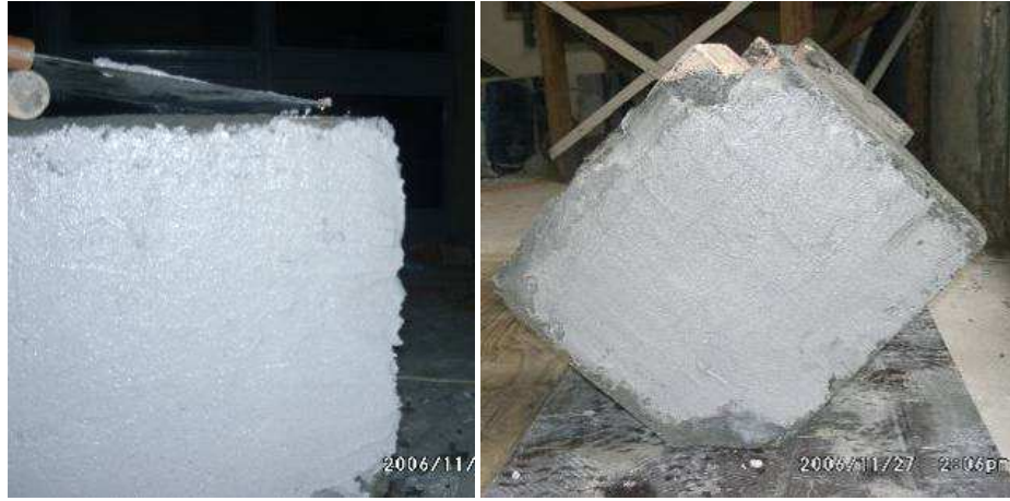
Şekil 4.29: Numunelerin Yüzeylerine Epoksi Harcı Uygulanması
