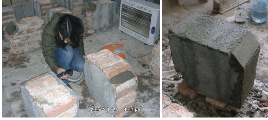
Şekil 4.27: Numune Yüzeylerine Tamir Harcı Uygulanması
