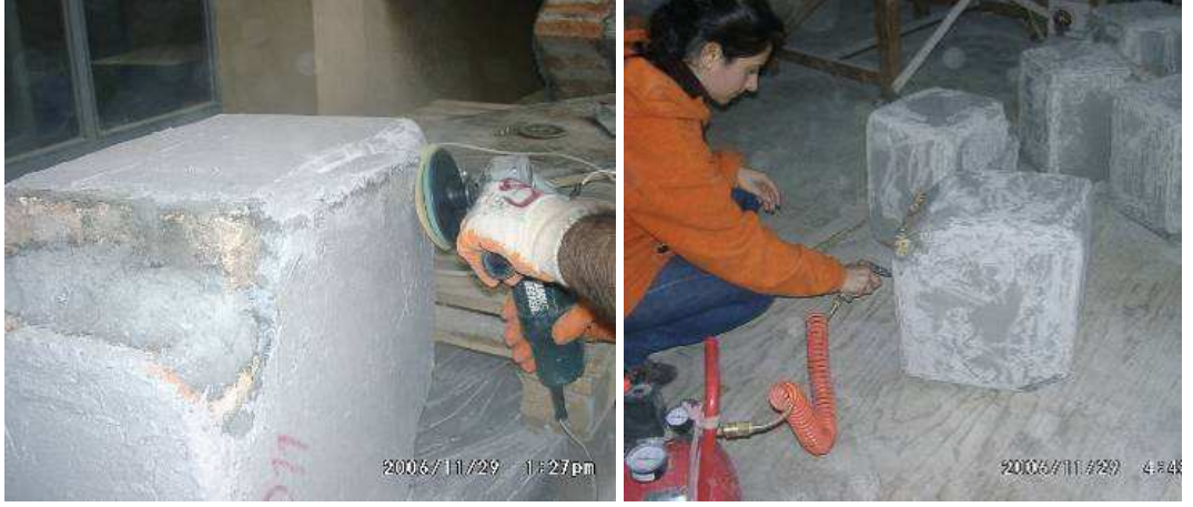
Şekil 4.30: Numunelerin Köşelerinin Yuvarlatılması ve Yüzey Temizliği
