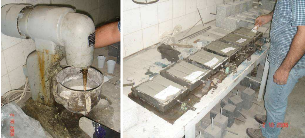
Şekil 4.19: Deneme Karışımı Dökümü
