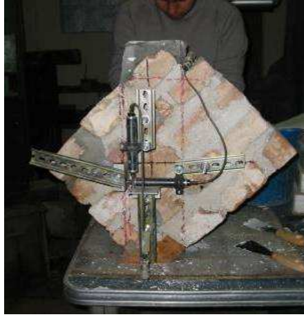
Şekil 4.43: Referans Numuneler İçin Ölçüm Düzeneği
