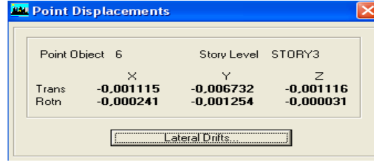
Şekil 5.59: 6 numaralı düğüm noktasının yerdeğiştirme ve dönme miktarları
