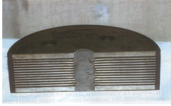
Şekil 4.4 : Kurşun çekirdekli kauçuk taşıyıcı
