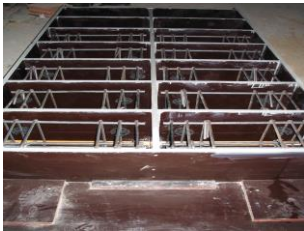
Şekil 3.3.3.2 Kare ve Silindir Enkesitli Numunelerin Donatı İskeletlerinin Yerleştirilmesi
