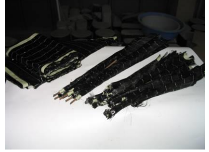
Şekil 4.3.5 CFRP Parçalarından Hazırlanan Ankrajlar
