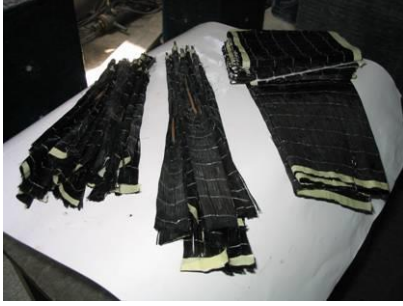
Şekil 4.3.5 CFRP Parçalarından Hazırlanan Ankrajlar
