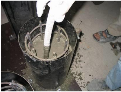
Şekil 3.3.4.2 Silindir ve Kare Enkesitli Numunelerin Beton Döküm Aşamaları
