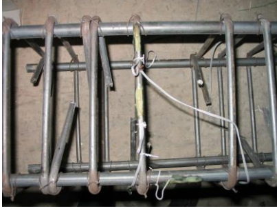
Şekil 3.3.2.2 Şekildeğiştirmeölçerlerin Üzerine Koruyucu N1 Sürülmesi
