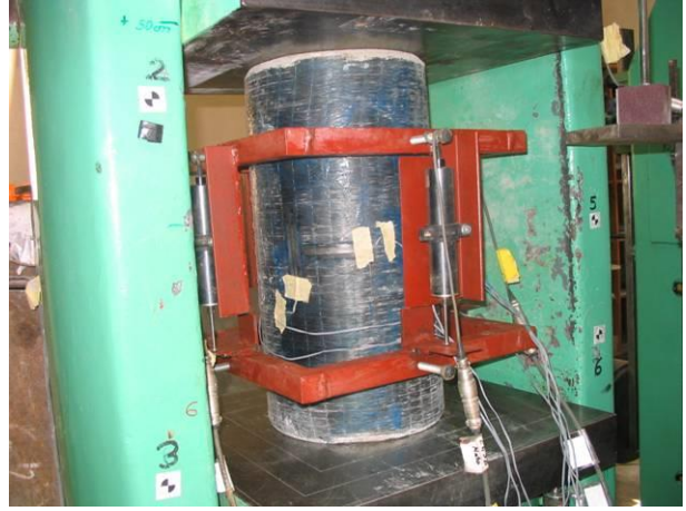
Şekil 5.4. Kare ve Silindir Numunelere Yapıştırılan Şekildeğiştirmeölçerler
