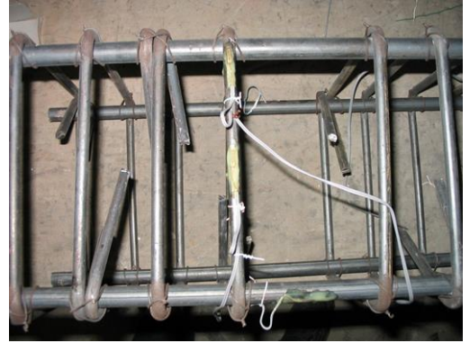
řekil 5.6. Enine ve Boyuna Donatılardaki řekildeğiřtirmeölçerlerin Konumları
