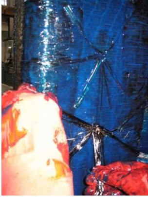
Şekil 4.3.8 Ankrajların Numune Yüzeyine Yapıştırılması
