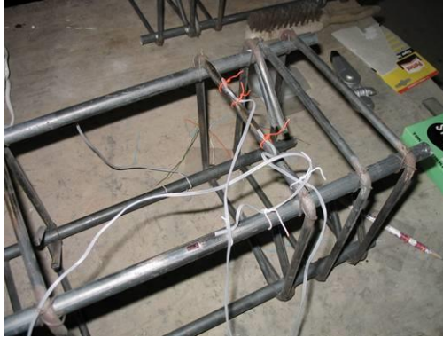
řekil 5.6. Enine ve Boyuna Donatılardaki řekildeğiřtirmeölçerlerin Konumları
