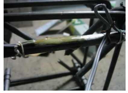
Şekil 3.3.2.2 Şekildeğiştirmeölçerlerin Üzerine Koruyucu N1 Sürülmesi
