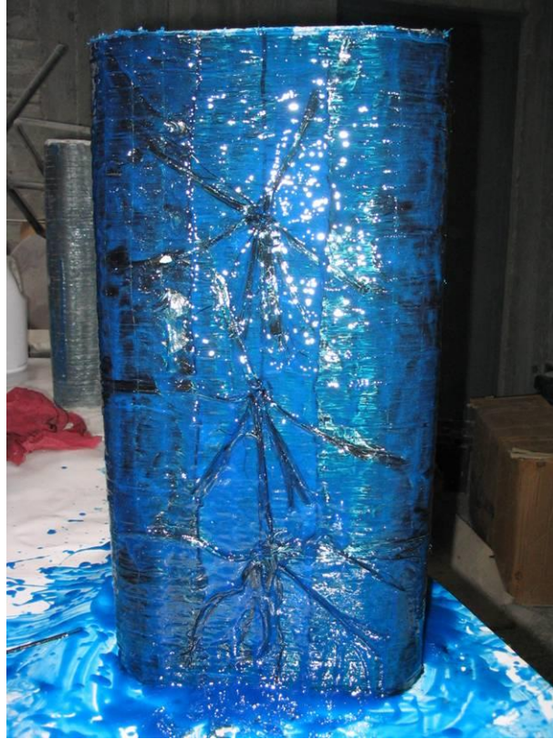
Şekil 4.3.9 Ankraj Yapıldıktan Sonraki Numune Görüntüsü
