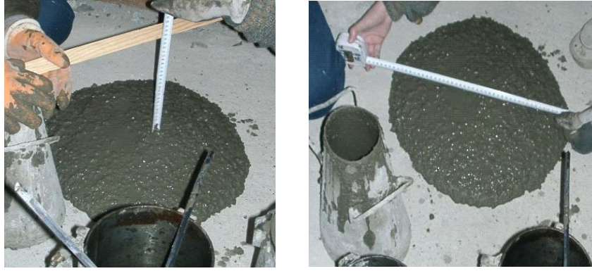
Şekil 3.4.1.1 Taze Betonda Çökme ve Yayılma Çapı Ölçülmesi
