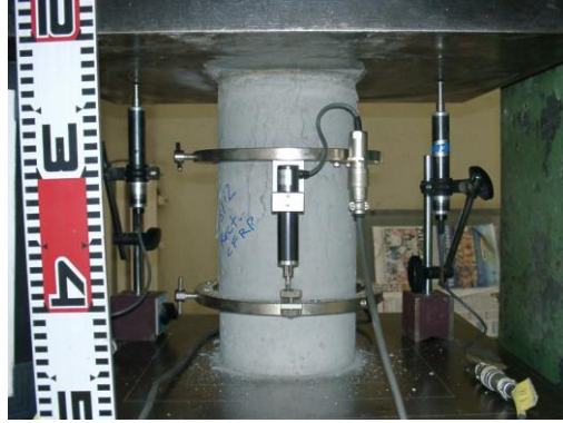
řekil 3.4.1.2 Standart Silindir Basıncı Deneyi İin Hazırlanan Dözenek
