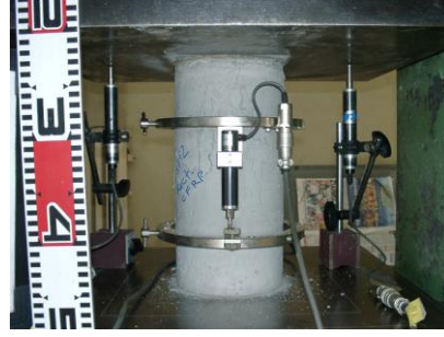
Şekil 5.1 Standart Silindir Basınç Deneyi İçin Hazırlanan Düzenek
