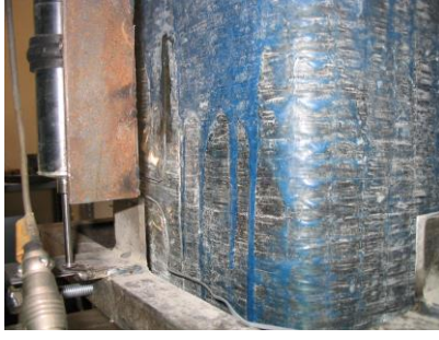
Şekil 5.3. Dikdörtgen Numunelerin Uzun ve Kısa Kenarlarına Yapıştırılan Şekildeğiştirmeölçerler
