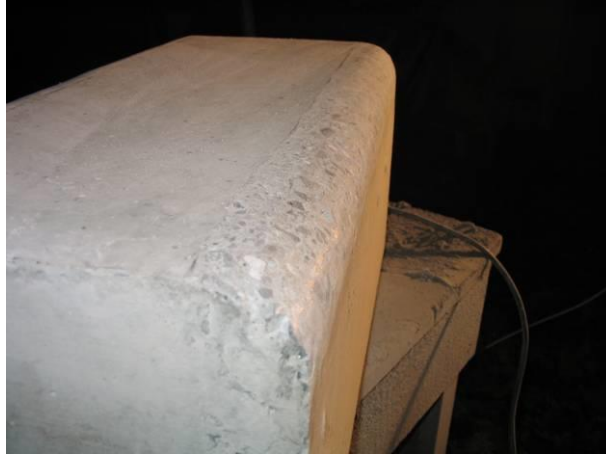
Şekil 4.2.2 Numunelerin Köşelerinin Yuvarlatılmış Hali
