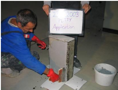
Şekil 4.2.6 Epoksi Esaslı Macun Karışımının Sürülmesi
