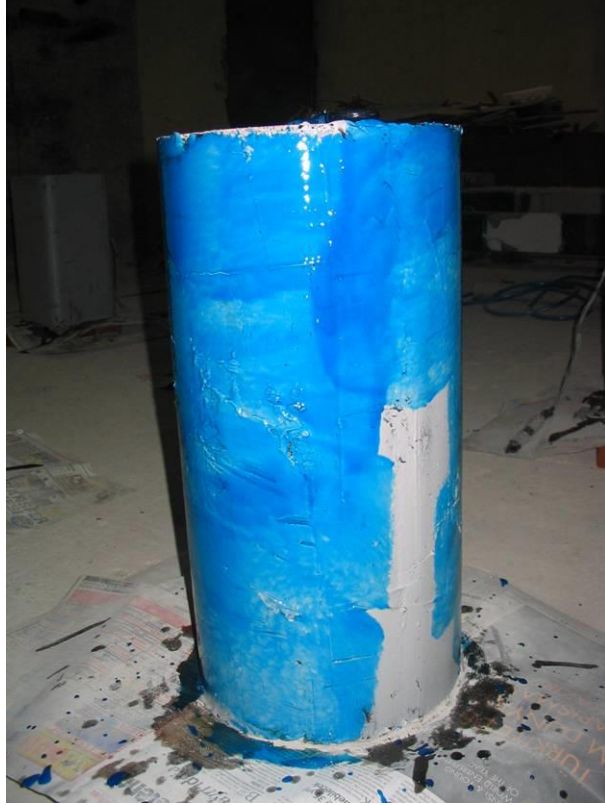
Şekil 4.2.8 Karbon Lif Tabakalar Sarılmadan Önce Epoksi Esaslı Yapıştırıcı Sürülmesi
