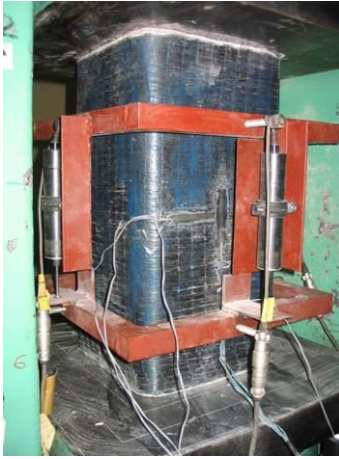
Şekil 5.4. Kare ve Silindir Numunelere Yapıştırılan Şekildeğiştirmeölçerler
