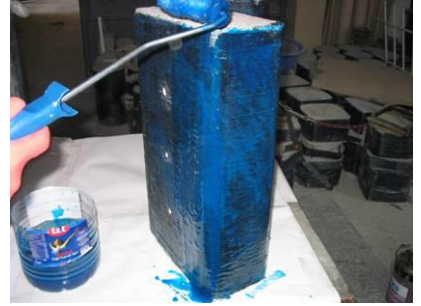
Şekil 4.3.6 Yapıştırıcının Hazırlanması ve Ankraj Yapılacak Yerlere Yapıştırıcının Sürülmesi
