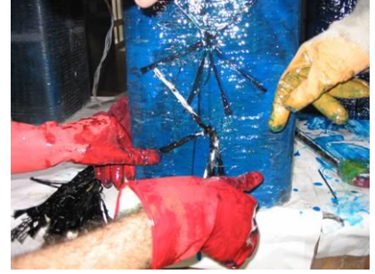
Şekil 4.3.8 Ankrajların Numune Yüzeyine Yapıştırılması
