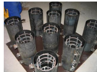
Şekil 3.3.3.2 Kare ve Silindir Enkesitli Numunelerin Donatı İskeletlerinin Yerleştirilmesi
