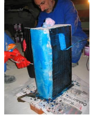
Şekil 4.2.8 Karbon Lif Tabakalar Sarılmadan Önce Epoksi Esaslı Yapıştırıcı Sürülmesi
