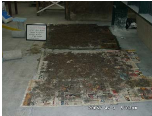
Şekil 2.6: Çelik Liflere Korozyon Oluşturmaya Çalışılması
