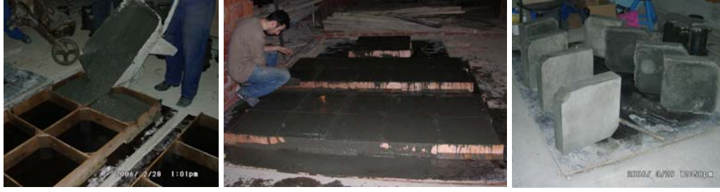
Şekil 1.1: Beton Elemanların Üretimi
