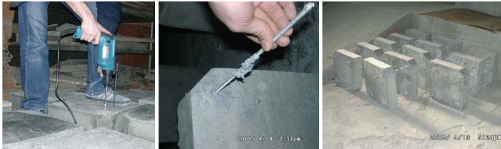
Şekil 2.33: Deney Düzeneği İçin Ankraj Uygulaması
