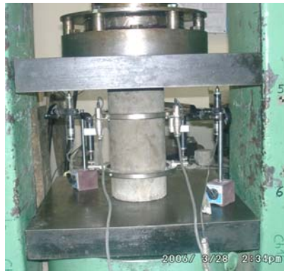
Şekil 3.1: Standart Silindir Basınç Deneyi Düzeneği
