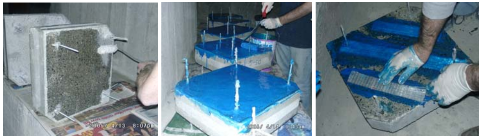
Şekil 1.3: Lifli Polimer Kompozitler İle Güçlendirme Uygulaması
