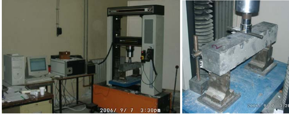
Şekil 2.17: RILEM Kırılma Enerjisi Deney Düzeneginin Genel Görünümü
