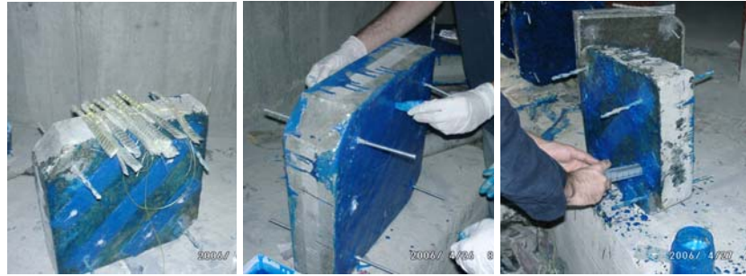
Şekil 2.38: DS-G-A-2 ve DS-G-M-A-3 Numunelerinde Ankraj Uygulaması
