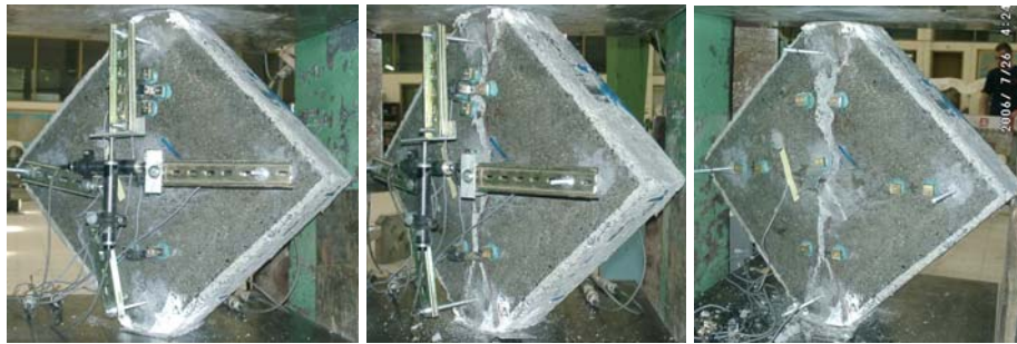
Şekil 5.53: DS-G-1-1side'in Deney Sırasındaki Görünüşleri
