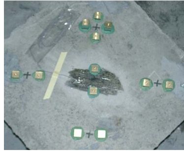
Şekil 4.5: Referans Elemanlarının Yüzeyindeki Şekildeğişimölçerler
