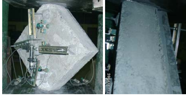
Şekil 5.14: DS-HPFRCC-3-1 side'ın Deney Sırasındaki Görünümleri
