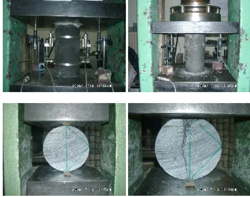
Şekil 3.9: HPFRCC Standart Silindir ve Yarma Çekme Deneyleri
