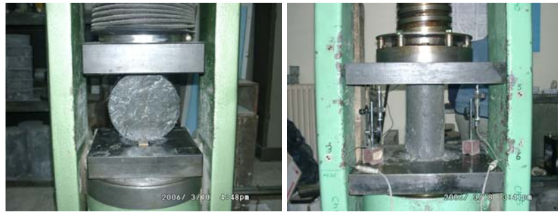
Şekil 2.3: Standart Yarma Çekme ve Basınç Deneyleri
