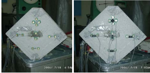
Şekil 4.6: Referans Elemanların Yüzeyindeki Yerdeğişirmeölçerler
