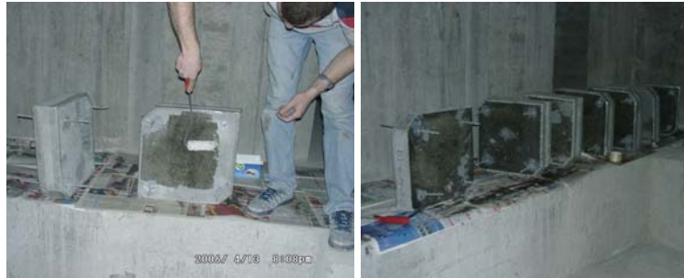
Şekil 2.35: Numune Yüzeylerine Astar Uygulanması
