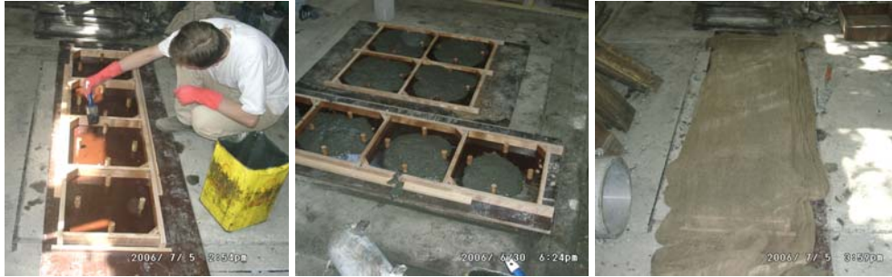
Şekil 2.27: HPFRCC Panellerin Kalıba Alınması ve Kür
