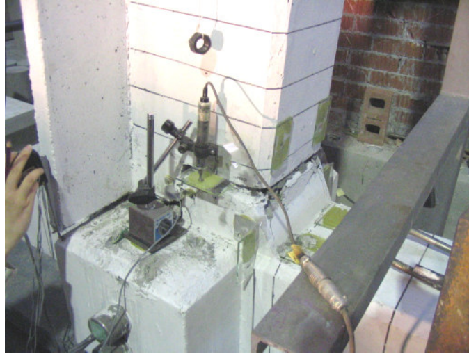
Şekil A. 4 Karma numune #1 kolon gusesi üzerindeki kalıcı deformasyonlar genel görünüş
