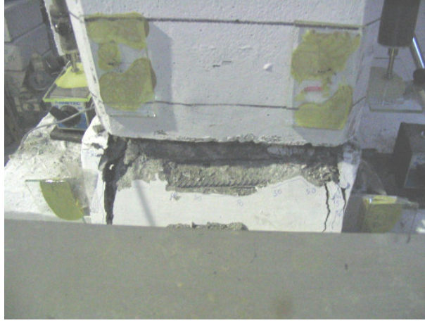
Şekil A. 8 Karma numune #1 1/10 dönme durumunda kolon gusesi üzerindeki deformasyonlar ön görünüş
