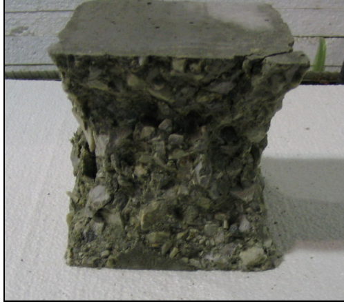
Şekil 3-27 : Kayma eksenli doğrultularında kırılmış beton test numunesi
