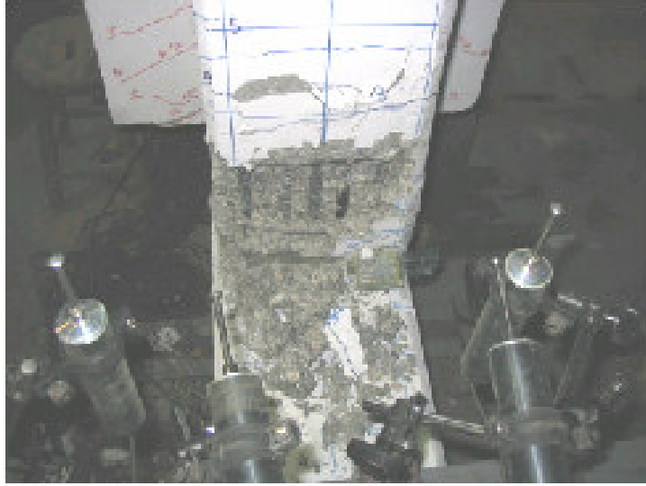
Şekil A. 14 Yekpare numune #2, deney sonu kalıcı depormasyonlar ön görünüş.
