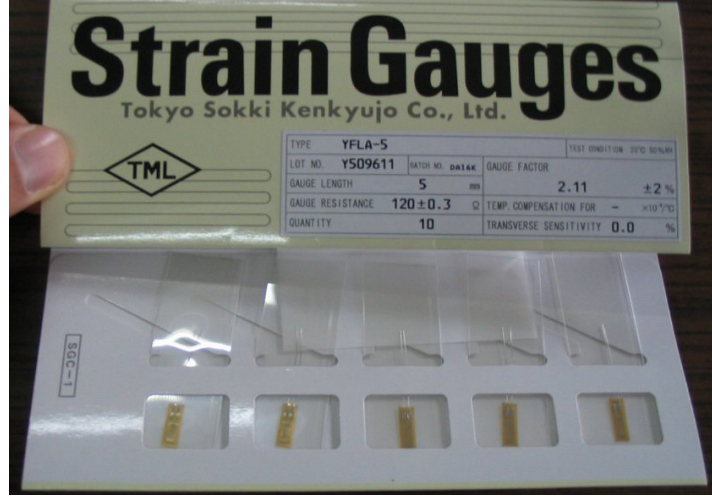
Şekil 3-9 : Akma ötesi okuma yapabilen gerilme ölçerler (YFLA-5-11)
