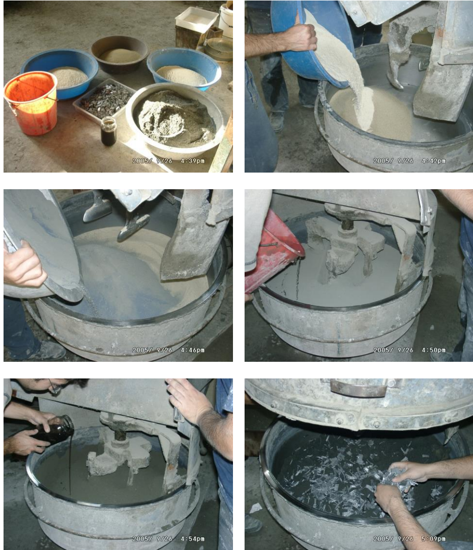
Şekil 2.5 Karışım II için Karıştırma Sırası
