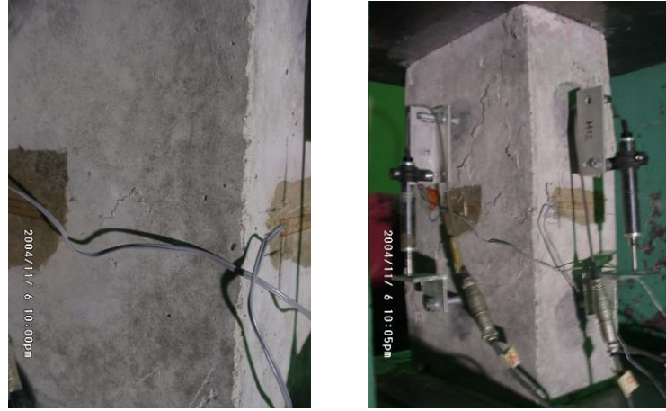
Şekil 4.4 Referans Elemanlarının Yüzeyindeki Şekildeğişimölçerler
