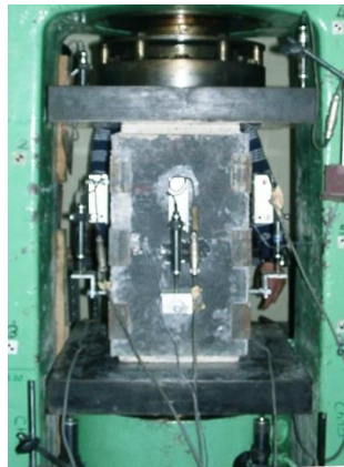
řekil 4.6 LS-R-1-15-M-I Elemanın Ölçüm Düzeneęi
