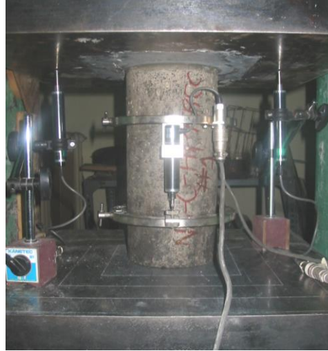
Şekil 3.1 Standart Silindir Basınç Deneyi Düzenegi
