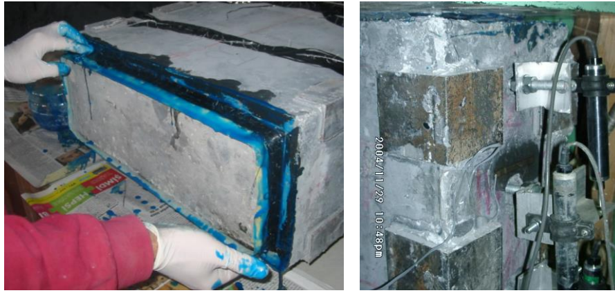
Şekil 4.8 LS-R-2-30-M-I Elemanının Ölçüm Düzeneği ve CFRP Uygulaması
