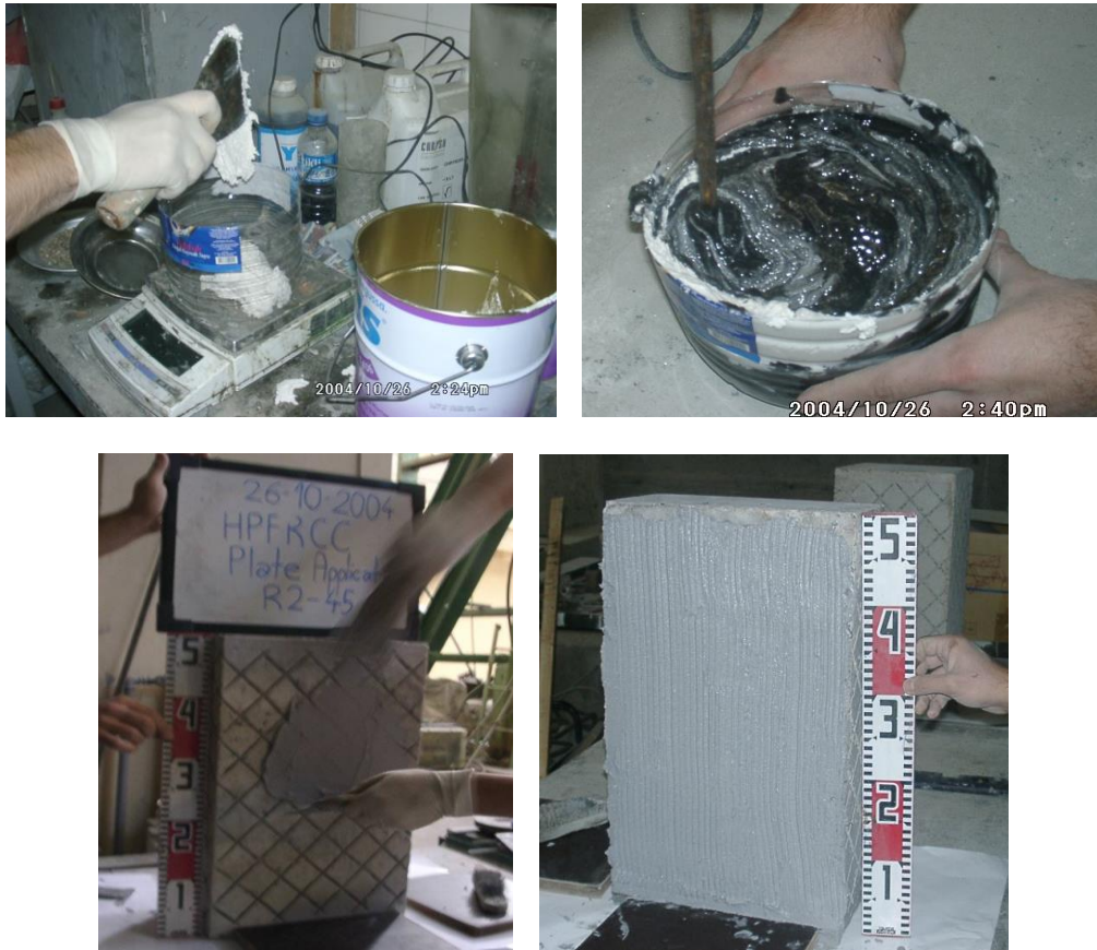
Şekil 2.11 Güçlendirilecek Elemanların Yüzeylerine Epoksi Harcı Uygulanması
