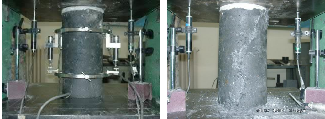
Şekil 3.10 HPFRCC Standart Silindir Basınç Deneyi
