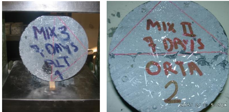
Şekil 3.11 HPFRCC Yarma Çekme Deneyi
