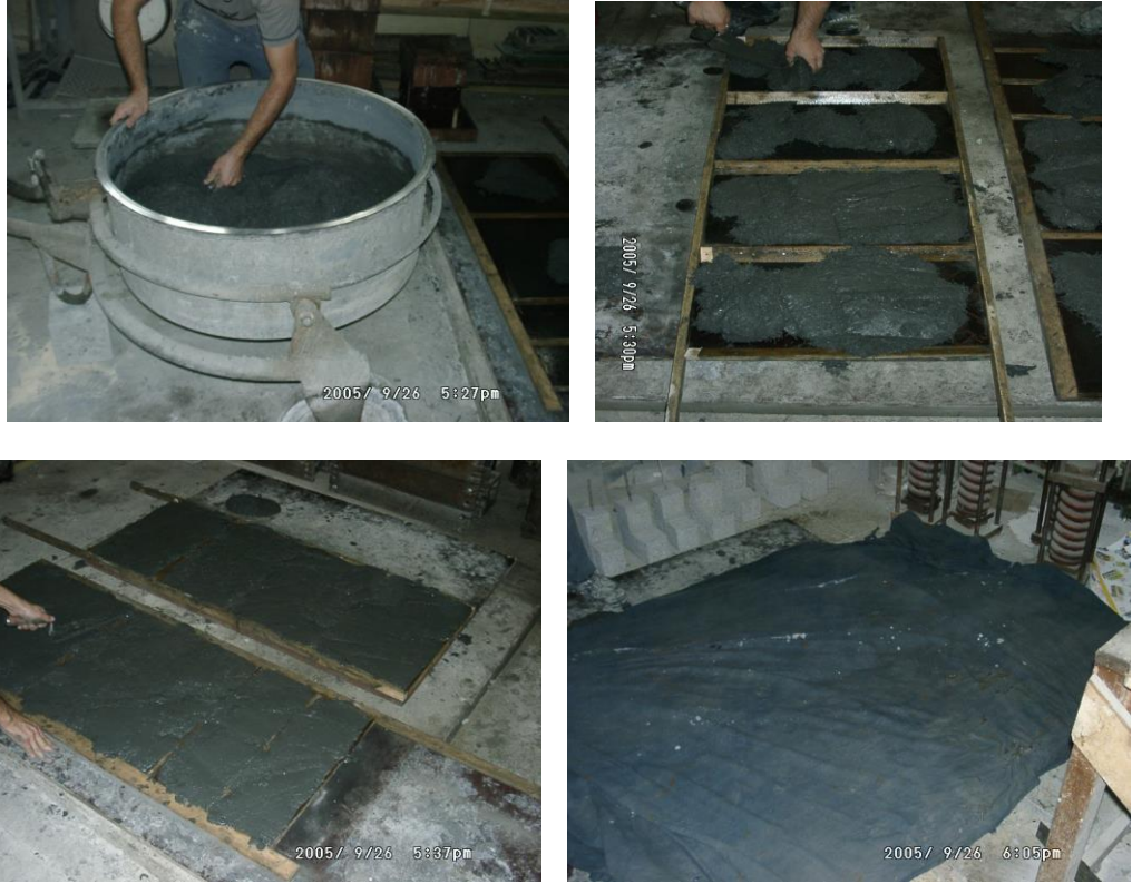
Şekil 2.8 HPFRCC Panellerin Kalıba Alınması ve Kürü
