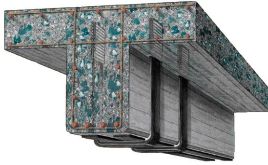
Şekil 5.37 – Kesme dayanımı FRP şeritlerle artırılmış betonarme kesit [33]
