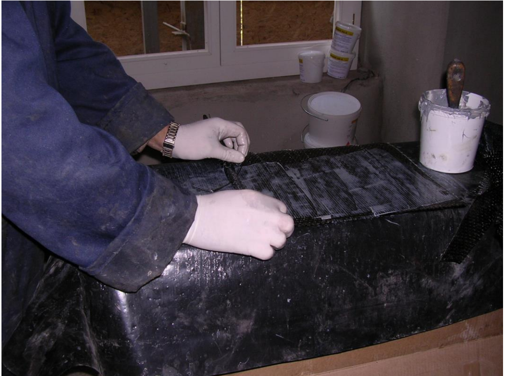
Reçineli bu parçalar sarılarak rulo haline getirilir.
