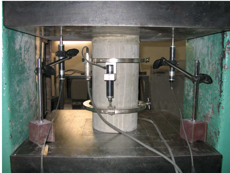
Şekil 3.7 Standart Silindir Deneyi Düzeneği
