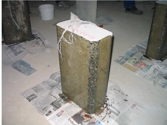
Şekil 4.5 Astar Karışımın Sürülmesi
