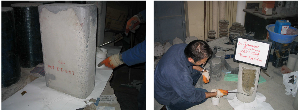
Şekil 4.8 Önceden Hasar Verilen Numunenin Onarımı ve CFRP Sargı İşlemi
