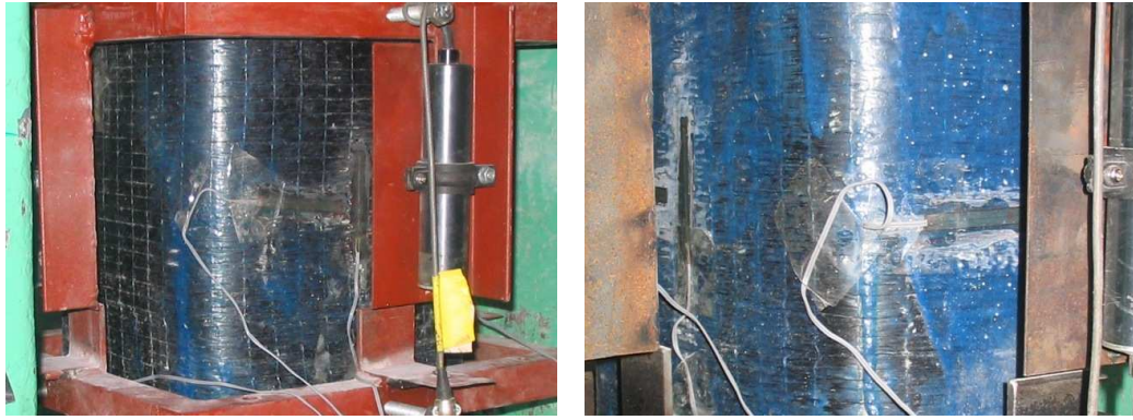
Şekil 5.3 Numune Yüzeyindeki Şekildeğiřtirmeölçerler
