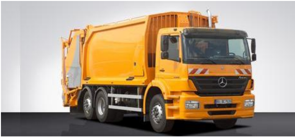
Şekil 2.9 : Mercedes, hidrolik sıkıştırırmalı çöp kamyonu (Url-16).
