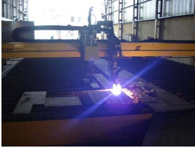
Şekil 3.3 : Sac panel kesim işlerinde kullanılan CNC tezgahı.
