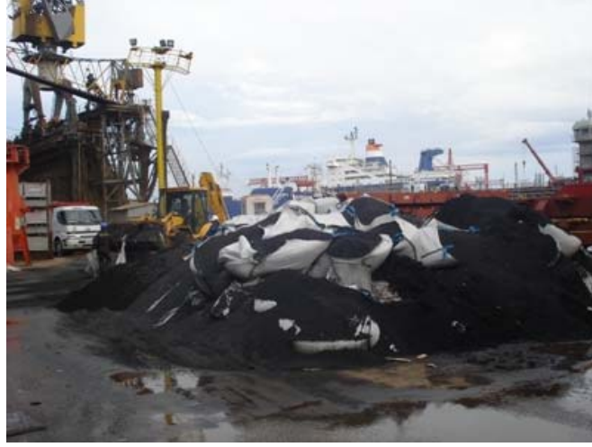
Şekil 4.3 : Raspalama faaliyeti sonucu oluşan atıklar.
