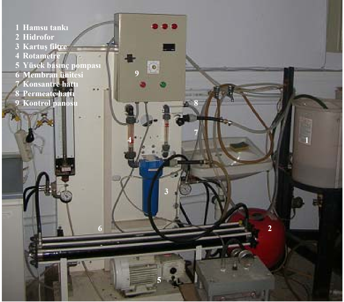
Şekil.4.1: Pilot ölçekli ters osmoz tesisi
