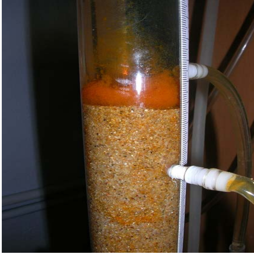
Şekil A5: 5.0 mg/L demir konsantrasyonu ve 9.34 m/saat filtre hızında işletilen filtrenin geri yıkmaya başlama görünümü ( \epsilon :0.36, musluk suyu)
