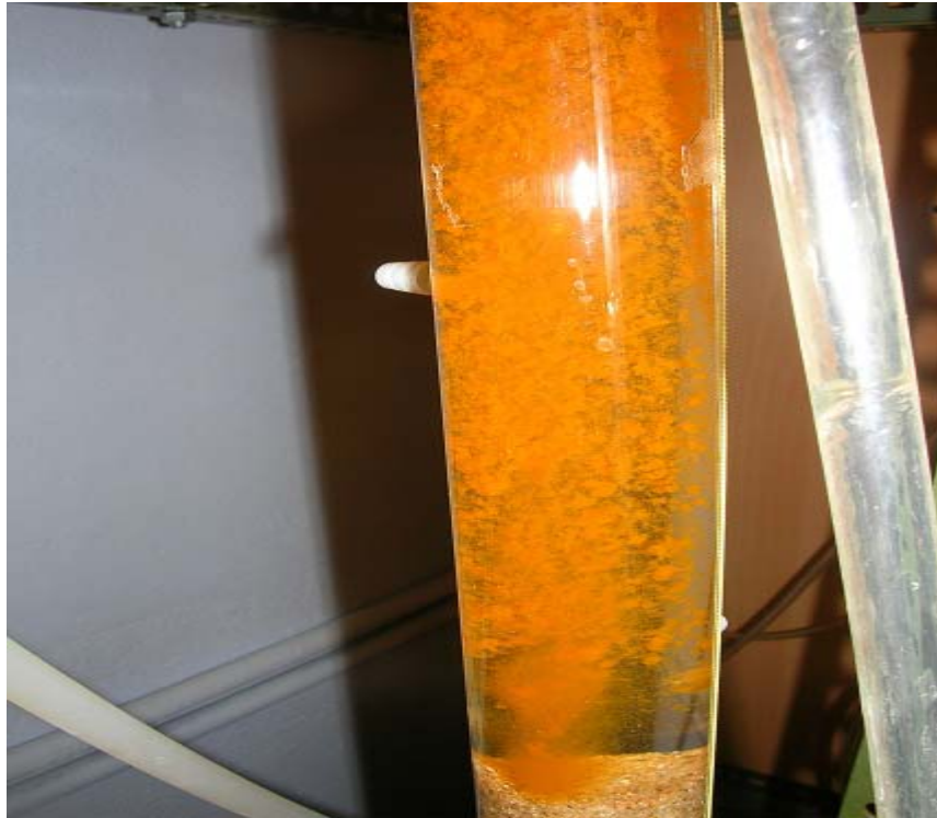
Şekil A6: 5.0 mg/L demir konsantrasyonunda işletilen filtrenin geri yıkama görünümü ( \epsilon :0.36, deiyonize su)
