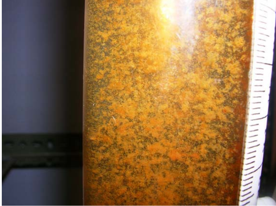
Şekil A8: 5.0 mg/L demir konsantrasyonu filtrenin geri yıkama esnasında demir partiküllerinin görünümü ( \epsilon :0.36, deiyonize su)
