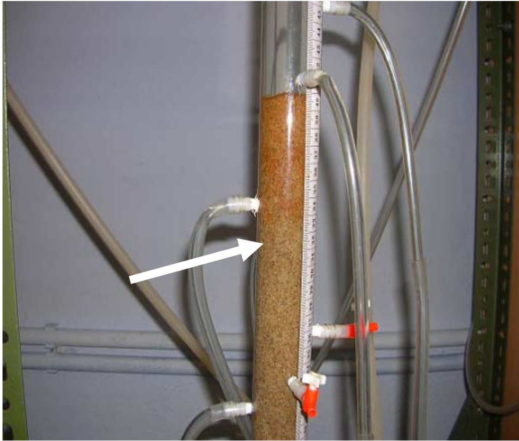
Şekil 5.36: Filtre yatağı içersinde demir ilerlemesine ait örnek bir görüntü
