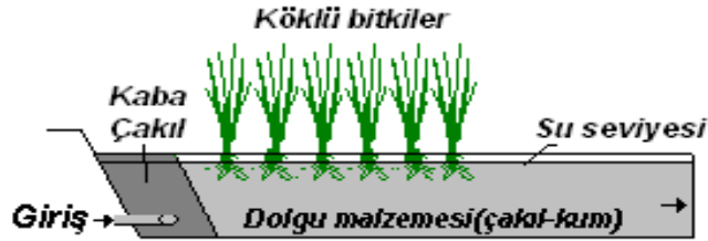
Şekil 2.3: Yatay yüzeyaltı akışlı (Y-YAAS) bir sulakalan sistemi
