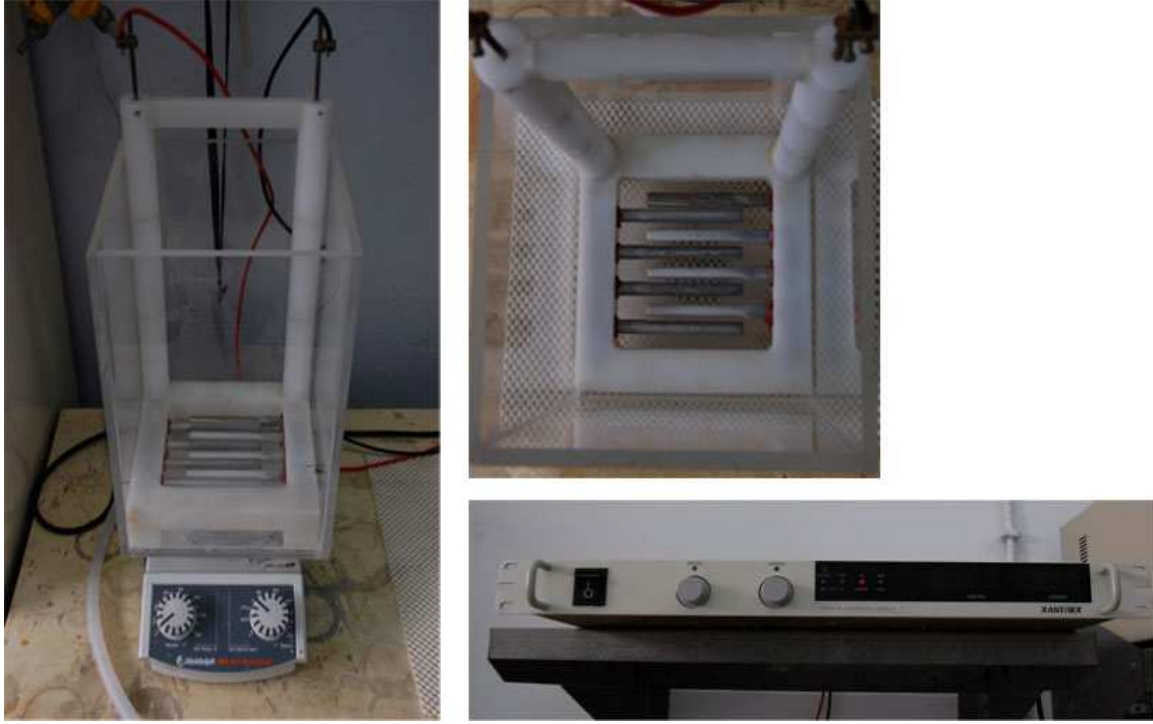
Şekil 6.1: Deneysel çalışmada kullanılan elektrokoagülatör ve güç kaynağı
