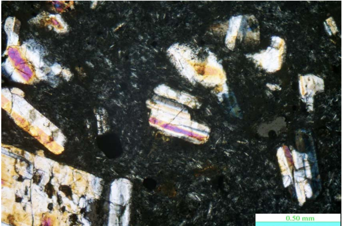
Şekil 2.8: Göynük mevkiinden alınan dasit numunesinin polarizan mikroskop görüntüsü (Çift nikol). Kesitte plajiyoklaz fenokristallerinin cam içeren ince taneli, kristalin bir matriks içinde yer aldığı görülmektedir.
