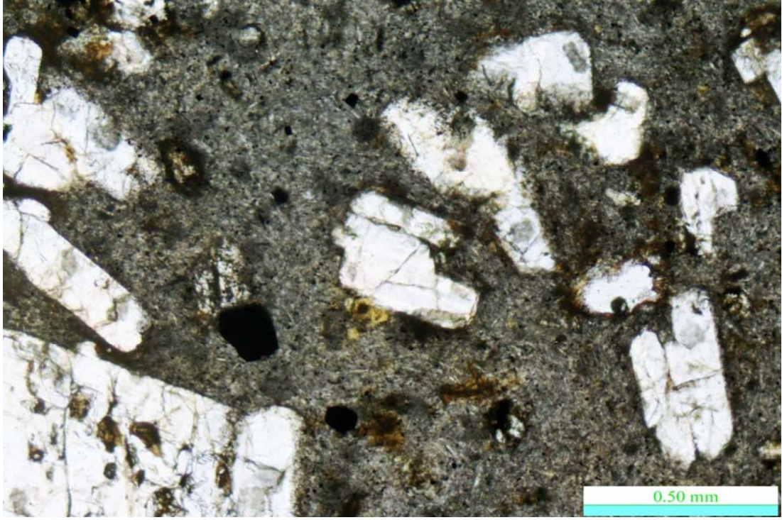
Şekil 2.9: Göynük mevkiî'nden alınan dasit numunesinin polarizan mikroskop görüntüsü (Tek nikol). Özşekilli (kübik) opak mineraller pirit olabilir
