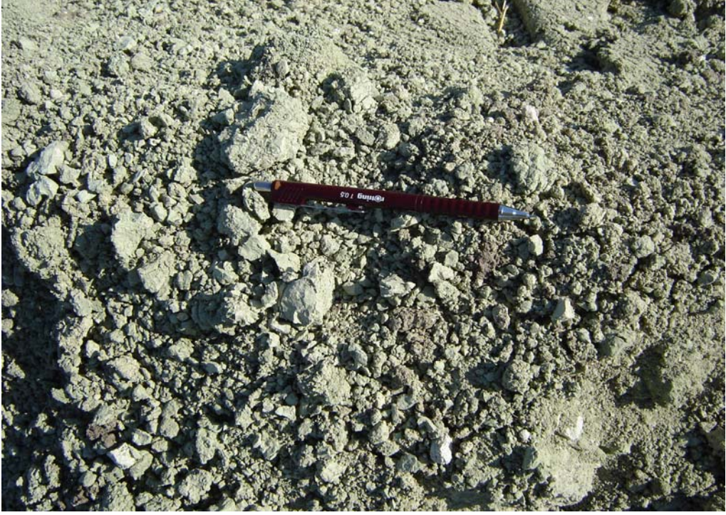
Şekil 2.14: Çalışma sahasının kuzey batı kesimlerinde Kıran Derenin batı kollarında izlenen arjilik alterasyon ürünü kil oluşumu. XRD çalışmaları sonucu smektit grubu killeri olduğu anlaşılmıştır.
