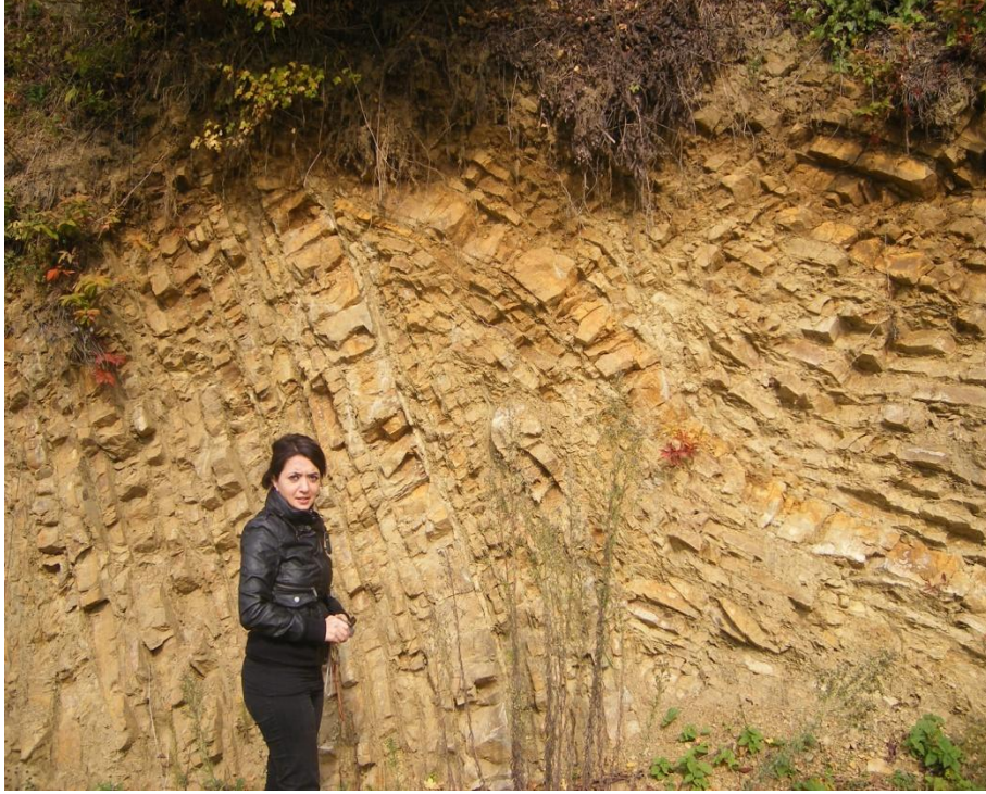
Şekil 3.3 : Baraj eksen yeri sağ sahilde gözlenen bir mikro kıvrım.
