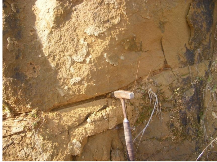
Şekil 4.32 : Sol sahilde ölçülen süreksizlik açıklığı.
