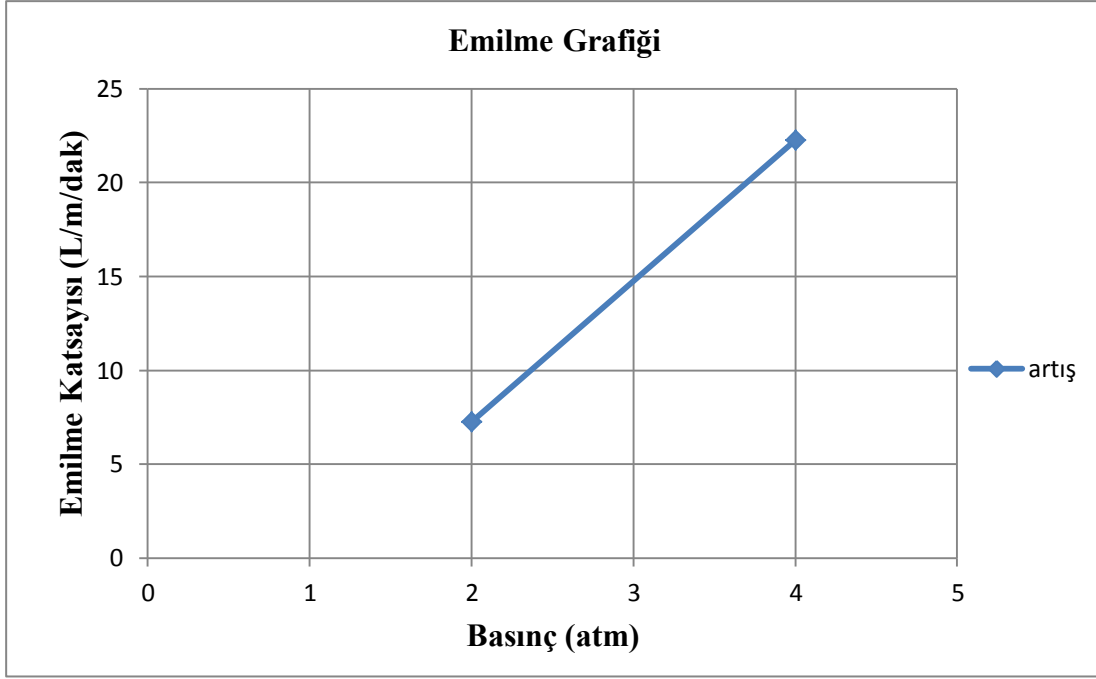
Şekil A.7 : YSK-1 sondaj kuyusunun 16-18 m arası emilme katsayısı-basınç grafiđi
