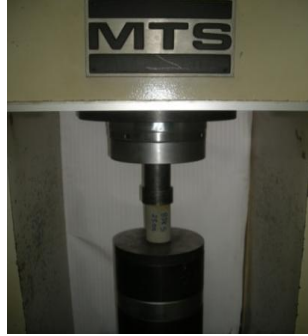
Şekil 4.7 : Numunenin yüklem tablalarına yerleştirilmesi.
