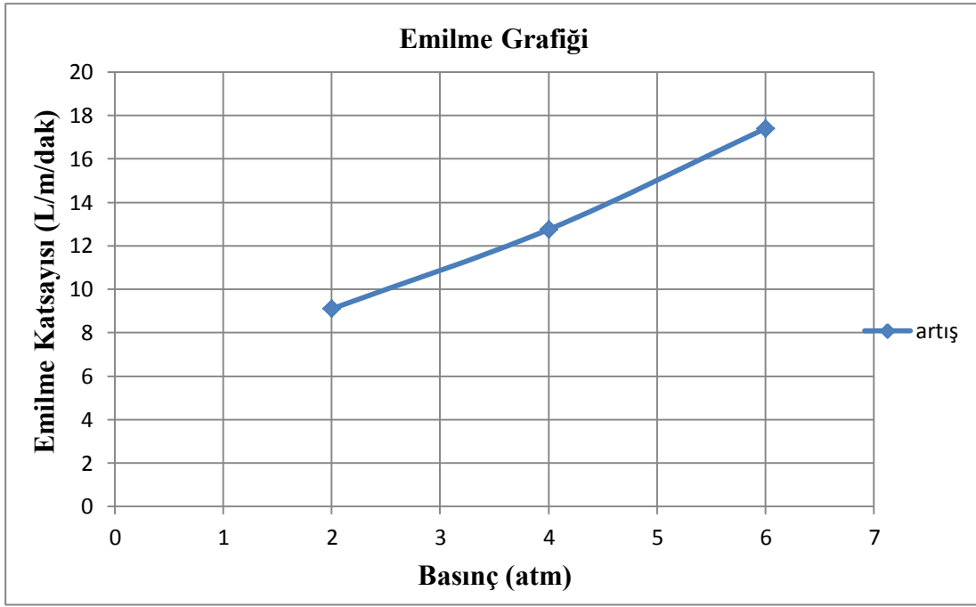
Şekil A.15 : YSK-1 sondaj kuyusunun 58-60 m arası emilme katsayısı-basınç grafiđi
