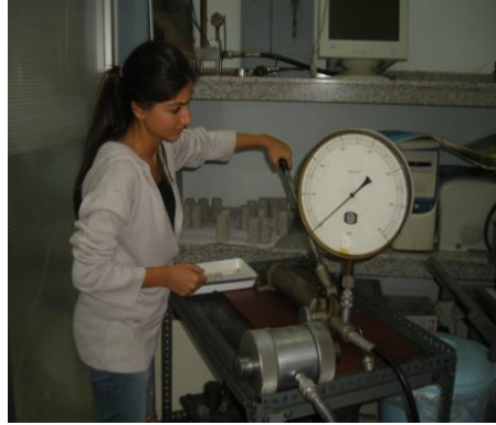
Şekil 4.9 : Üç eksenli basınç deneyinde yenilme değerinin okunması.
