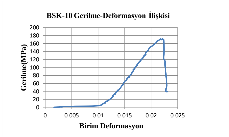
Şekil 4.27 : BSK-10 nolu sondajın 25.80 metredeki gerilme-deformasyon ilişkisi.
