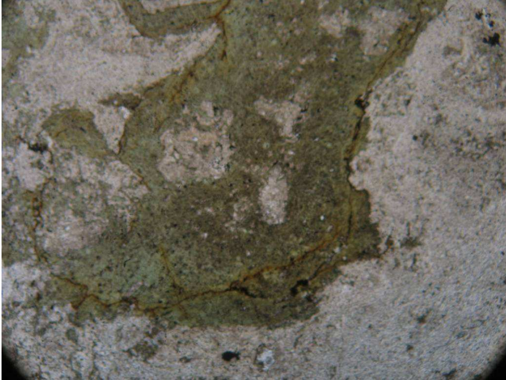
Foto 16 10 X büyütme, tek nikol, bir önceki fotonun tek nikol görüntüsü.Yeşil renkli gözlenen kloritleşmenin içinde kahverengi demir oksit damarcığı.
