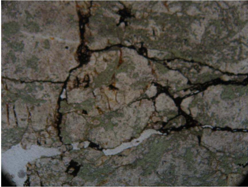
Foto 28 : 2.5 X büyütme, tek nikol, tek nikolde daha belirgin gözlenebilen yeşil renkli kloritleşme, kahverengimsi damarlar halinde izlenebilen demir oksit mineralleşmeleri.
