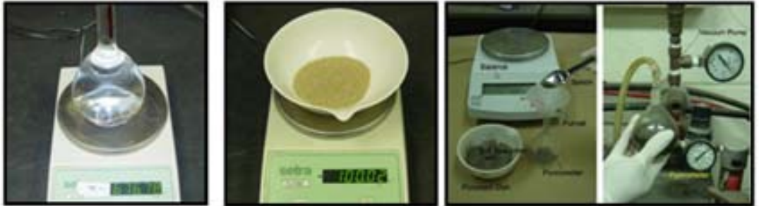
Şekil 4.7: Özgül Ağırlık Tayininde Kullanılan Aletler ( www.soiltest.html )
