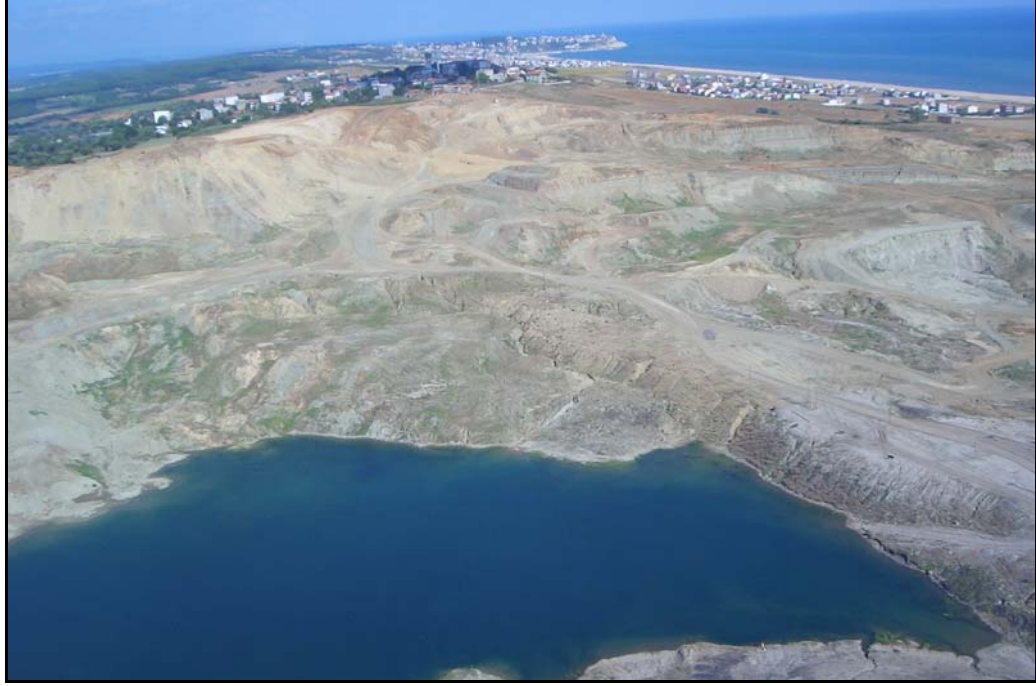
Şekil 5.2: Yeniköy Maden Sahası Üretim Çukurunda Oluşmuş Gölcük ve Geri Planda Harekete Duyarlı Şevler
