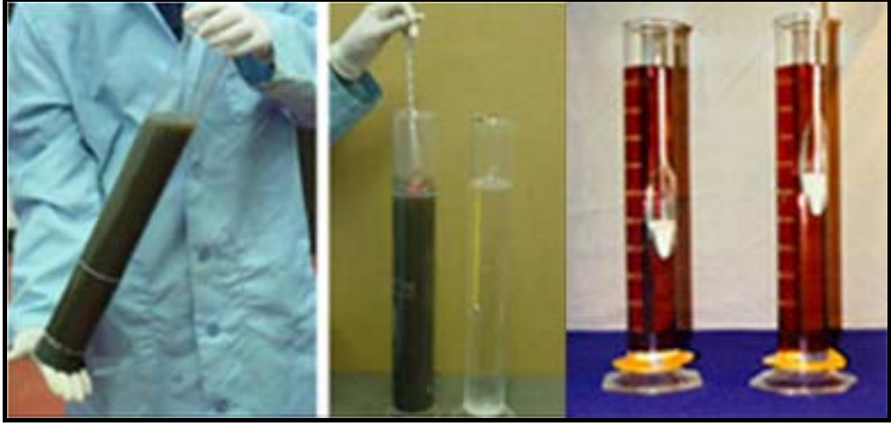
Şekil 4.4: Hidrometre Deneyi Uygulanırken Kullanılan Aletler ( www.soiltest.com.tr )
