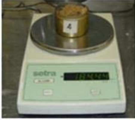
Şekil 4.6: Su Muhtevası Deneyinde Kullanılan Aletler ( www.soiltest.html )
