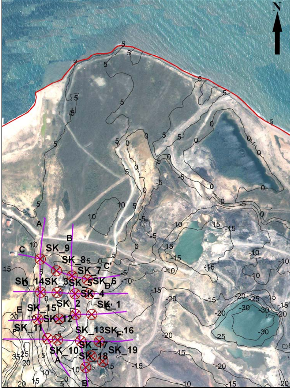
Şekil 4.2: Yeniköy Maden Sahasında Yapılan Sondajların Yerleri (Uydu görüntüsü 2005 yılına ait olup BİMTAŞ-İMP ‘den alınmıştır.) (Harita 1/5000 ölçekte hazırlanmıştır.)
