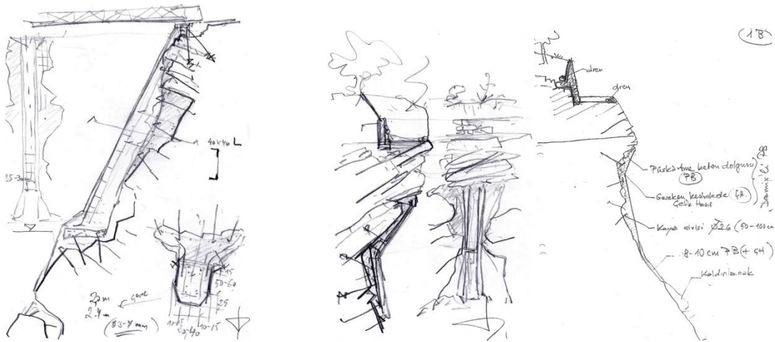
1-Asansör bölgesi destek kolonu imalatı
