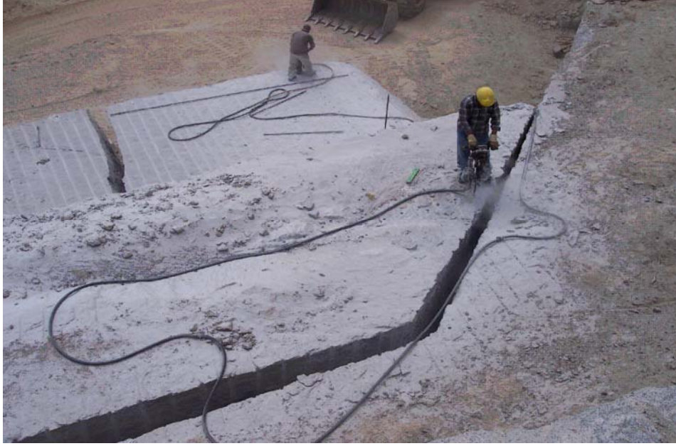
Şekil 3.18: Hidrolik delici tabancayla blokların şekillendirilmesi.
