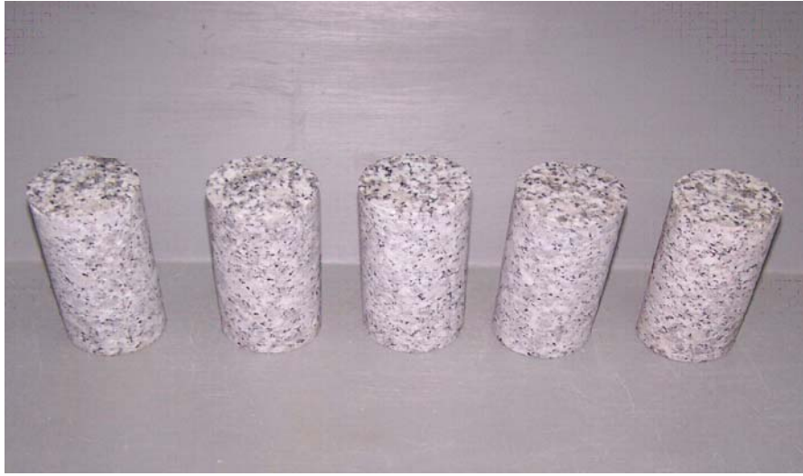
Şekil 3.37: Don öncesi tek eksenli basınç deneyi için hazırlanmış silindirik örnekler.
