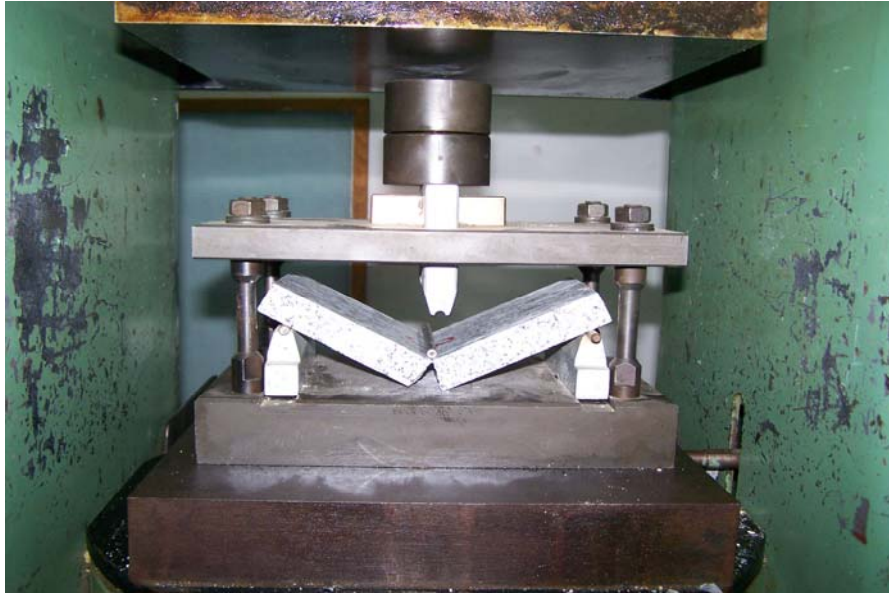
Şekil 3.44: Eğilme deneyinde kullanılan destek çeneti.
