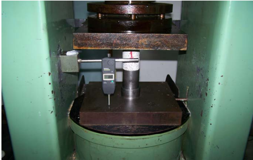
Şekil 3.38: Tek eksenli basınç deneyinde kullanılan 200 ton yükleme kapasiteli hidrolik pres.
