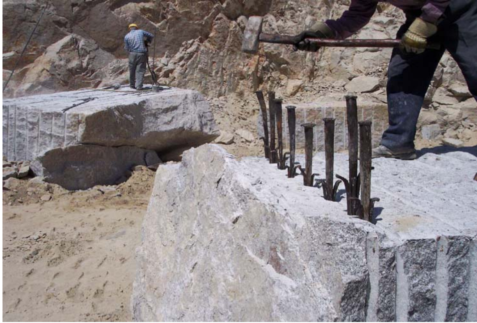
Şekil 3.19: Kamalama yöntemiyle blokların sayılanması.
