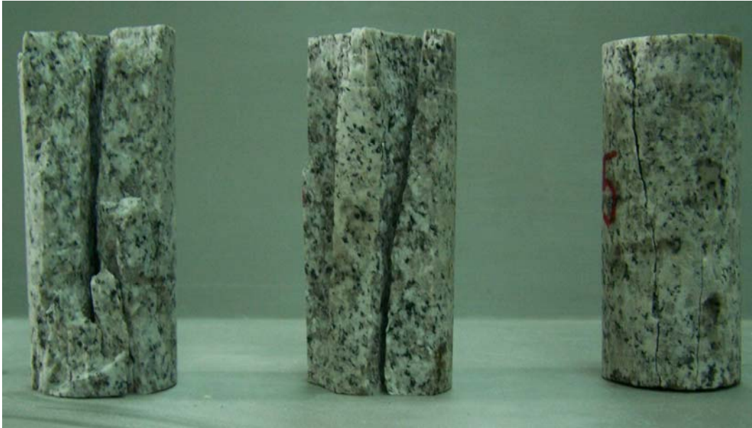
Şekil 3.39: Don sonrası tek eksenli basınç deneyi sonucu granit örneklerindeki kırılma şekilleri.
