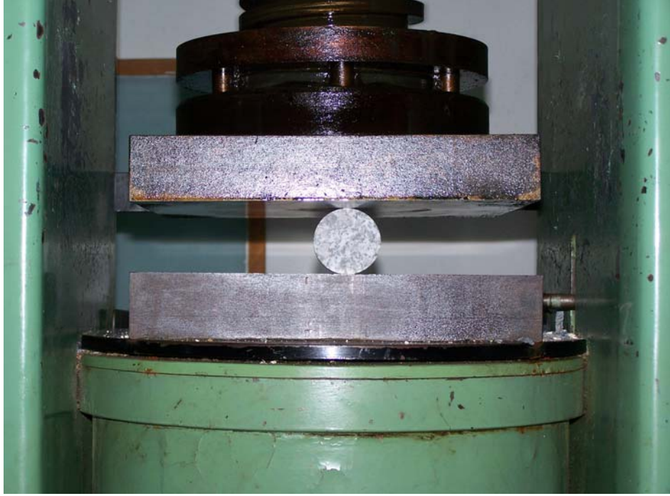
Şekil 3.41: Endirekt çekme deneyinde kullanılan 200 ton yükleme kapasiteli hidrolik pres.
