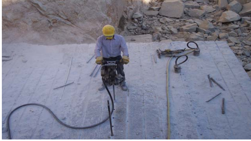
Şekil 3.11: Havalı delici tabancalarla granitin yüzeyine açılan delikler.
