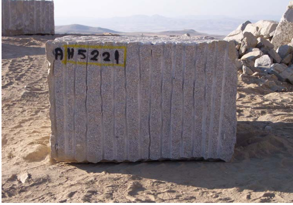
Şekil 3.20: Katrak kesimi için hazırlanmış iri hacimli blok.
