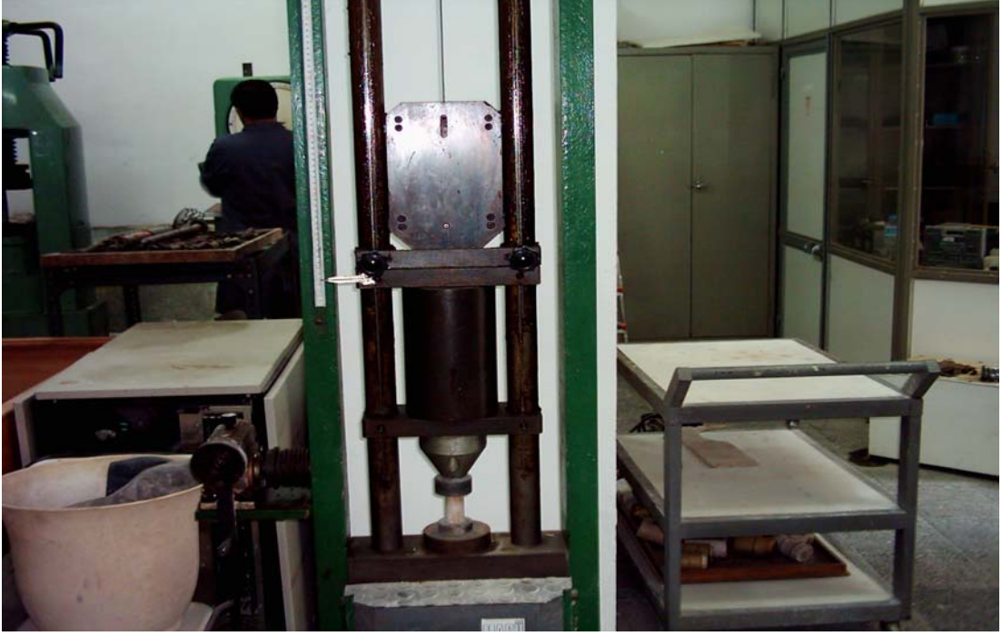
Şekil 3.42: Darbe direncinin belirlenmesinde kullanılan deney aleti.
