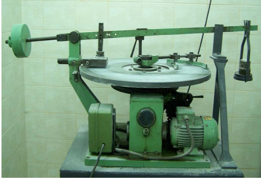
Şekil 3.45: Sürtüneli aşınma direncinin belirlenmesinde kullanılan deney aleti.
