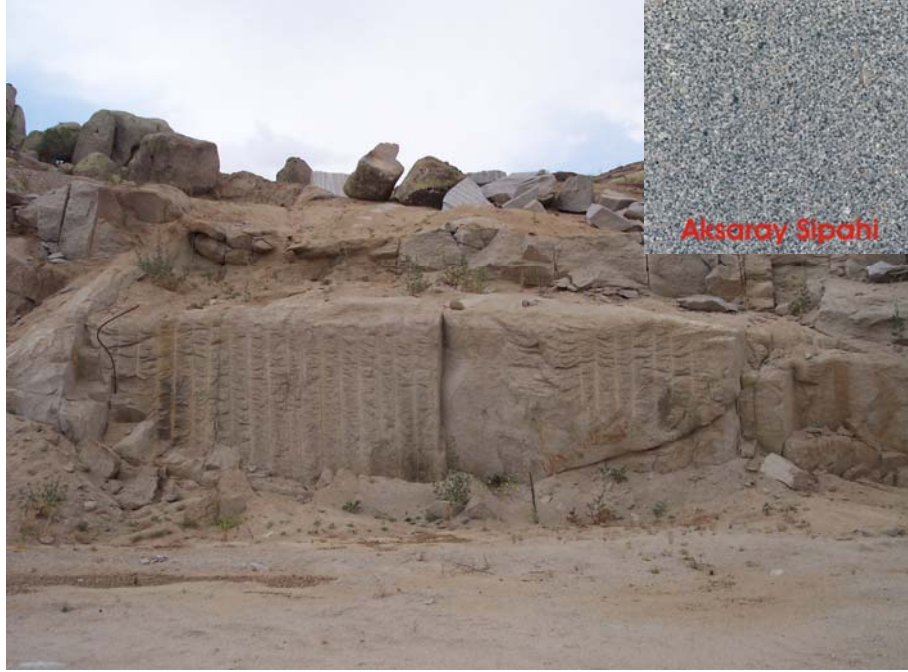
Şekil 3.4: Aksaray Sipahi granit ocağında gözlenen ayrışma.
