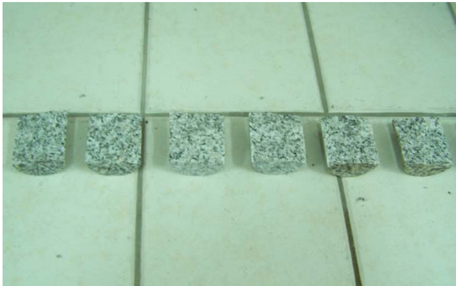
Şekil 3.40: Endirekt çekme deneyi sonrası kırılmış granit örnekleri.
