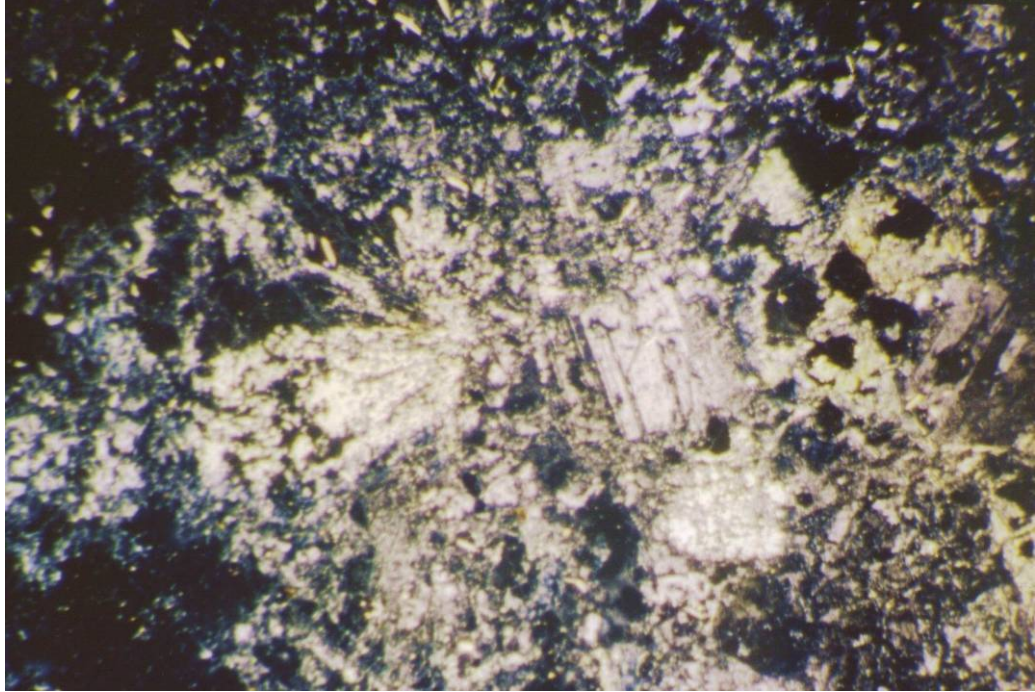
Şekil 3.8: Akçakese köyü doğusunda yüksek zeolitli tüf örneklerinin optik mikroskop görüntüsü. Altere olmaya başlamış iri fenokristaller görülmektedir (çift nikol B: x200). Hem mineral parçaları hem de matriks önemli derecede altere olmuştur.
