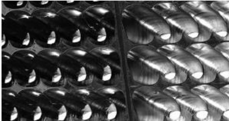
Şekil 4-21: Aygıtın çıkış tarafından çekilmiş bir fotoğraf. Hücresel yapı ancak bakış doğrultusu açısız yayılma bölgesi içerisinde olduğunda parlak görünmektedir [3].
