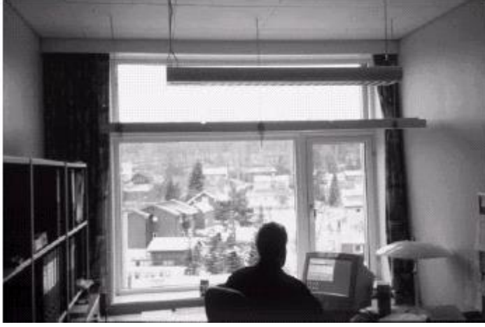
Şekil 3-14: Yarı saydam yüzeye sahip iç ışık rafı yerleştirilmiş test odasının içeriden görünüşü [3].
