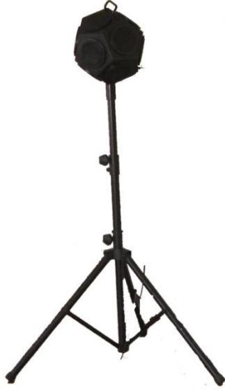
Şekil 4.17 : B&K 4295 omni hoparlör ve B&K UA 0801 tripod.
