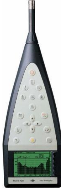
Şekil 4.14 : B&K 2260 ses düzeyi ölçer.
