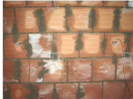
Şekil 2.10 : Boşluklu tuğla numunesi ve inşa edilen duvar (Semprini & Barbaresi, 2008).
