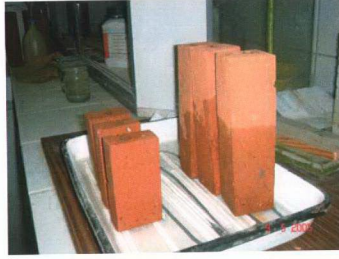
Şekil 7.4: Kılcallık hesabı için tuğlaların su içine yerleştirilmesi
