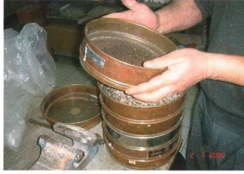
Şekil 7.2: Kumun elek analizi
