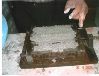
Şekil 7.12: 4x4x16 harç numunelerinin üretimi
