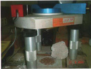
Şekil 7.19: Aderans deneyinde harçların tuğladan kopma anı
