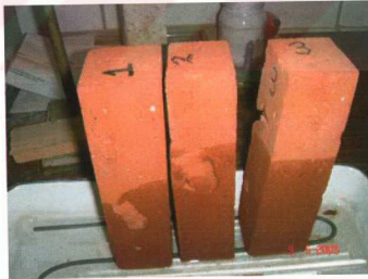
Şekil 7.5: Tuğlaların kılcallık yolu ile su emmesi
