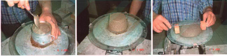
Şekil 7.10: Harçlara uygulanan yayılma deneyi
