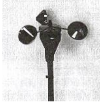
Şekil 4.11 Rüzgar Hızı Akıllı Sensörü
