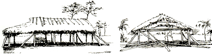
Şekil 2.23. Sıcak nemli bölgelerdeki yapı tipi. (Lechner, 1991)
