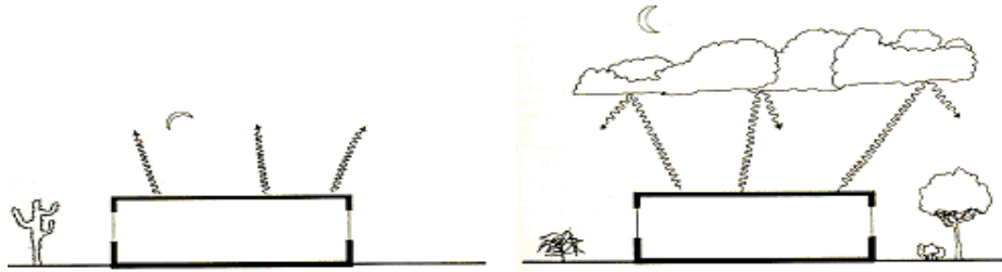
Şekil 2.39. Radyant soğutma. (Lechner, 1991)
