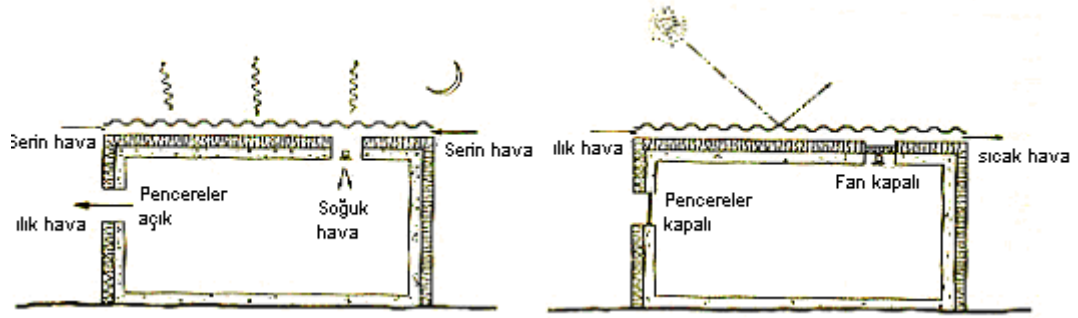
Şekil 2.41. İndirekt radyant soğutma. (Lechner, 1991)
