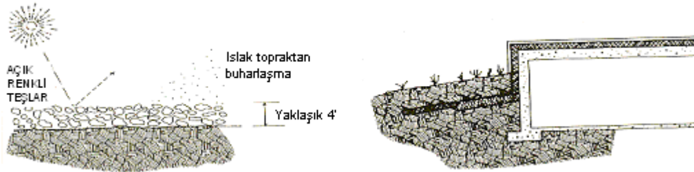
Şekil 2.44. Direkt toprak soğutması. (Lechner, 1991)
