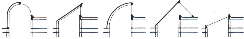
Şekil 6.28 Kütüphane binasının güneye bakan düşey çatı penceresini ve kısmen cam olan kemerli litriumunu gösteren kesit (Lam, 1986).
