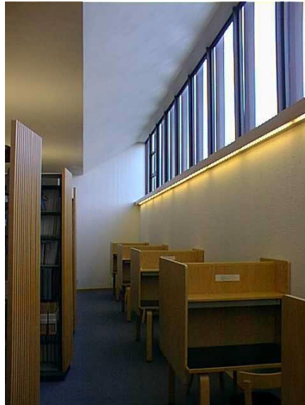
Şekil I.9 Açık karellere yüksekte bulunan bant şeklinde pencere dizisinden alınan gün ışığı ( http://www.mtangel.edu ).
