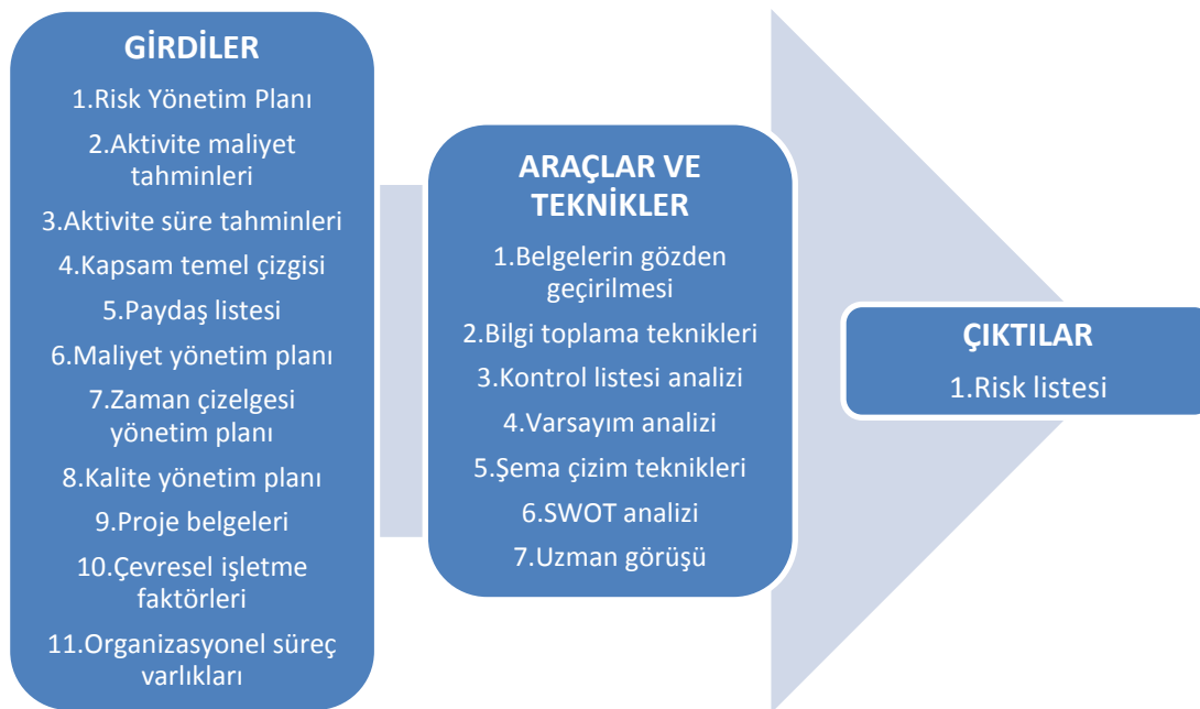
Şekil 4.3 : Risklerin tanımlanması (PMBok, 2008).
