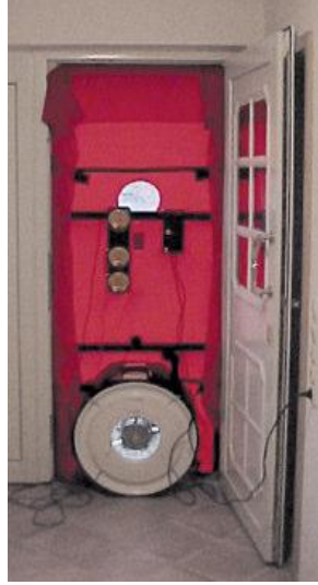
Şekil 5.3 : Üfleme kapı testi (blower test) [21]
