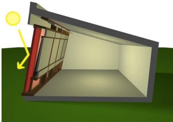
Şekil 5.61 : Dikey panelde hareketli güneş kontrolü
