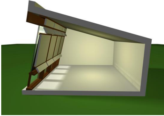
Şekil 5.56 : TAP'ın cephede dikey monte edildiği durum
