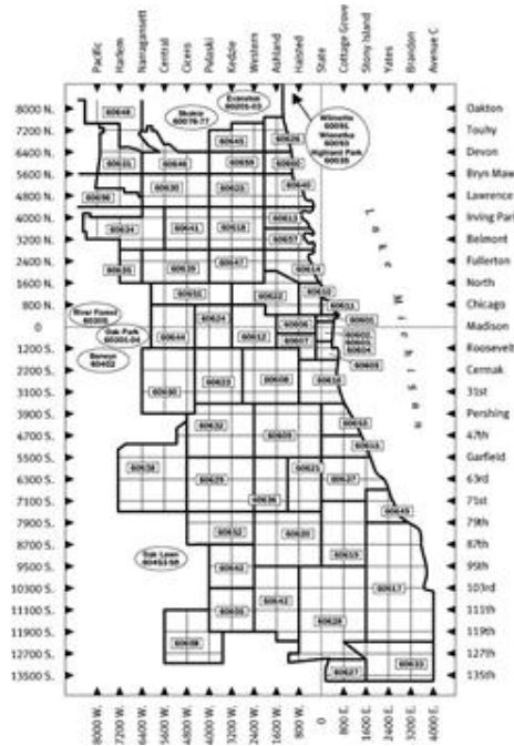
Şekil 4.75: Bir Chicago diyagramı.(Url-31). Grid üzerinde ana arterler, kentin belirlenen bir sıfır noktasından dört yöne doğru genişlemesi ve gride/bloklara göre sayısal olarak tanımlanmasını gösteren bir ulaşım diyagramı.
