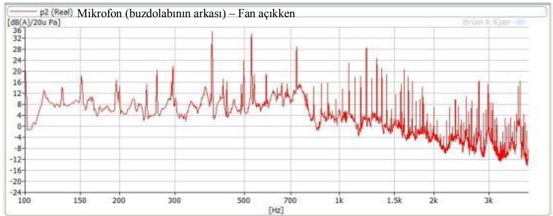
Şekil 2.35: NM4 için P2 (arka mikrofona) frekans spektrumu (dBA), fan AÇIK konumdayken.
