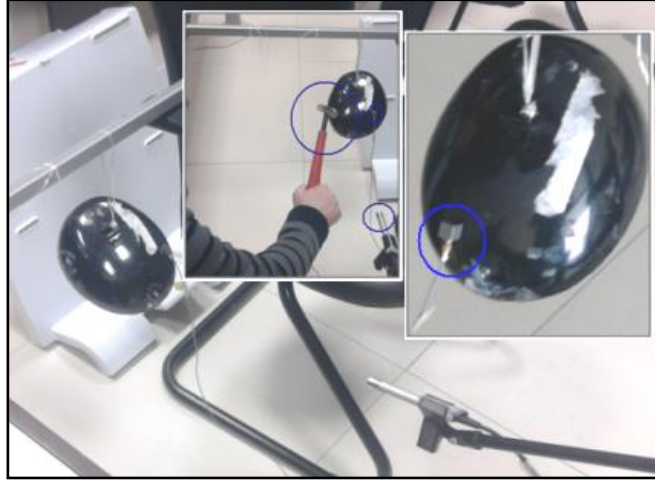
Şekil 2.62: Kompresör üst kabuğu FRF ölçüm düzeneği.
