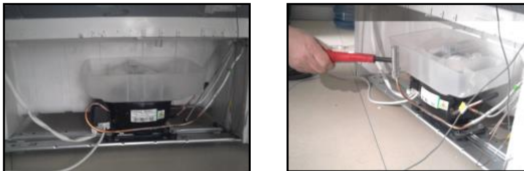
Şekil 2.51: NM4 kompresör şasi grubunun FRF ölçümüne ait bir görüntü.
