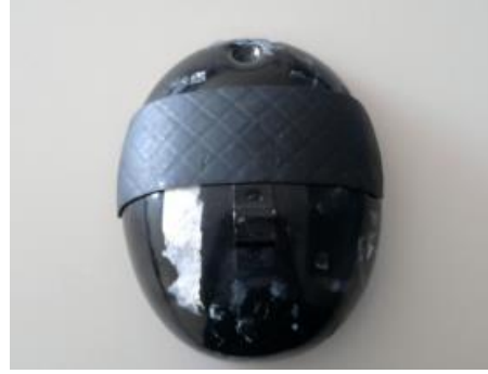
Şekil 2.65: Visko-elastik bir sönümleyici malzeme ile kaplanmış kompresör üst kabuğu.
