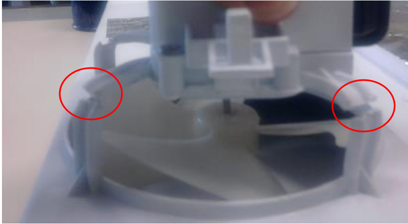
Şekil 2.78: Yerinden söküldükten sonra sanki yerindeymiş gibi temassız tutturulmuş şekilde çalıştırılan fan.
